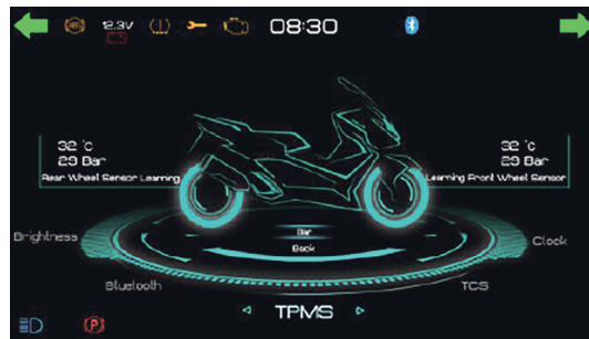
Фото 2.12. Панель контроля давления.
