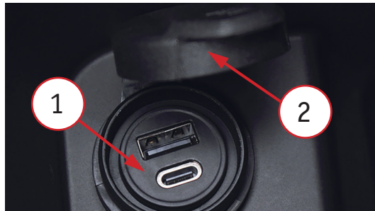
Фото 2.22. Разъемы: 1 – место размещения разъемов; 2 – защитная крышка.
