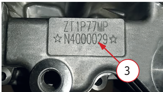
Фото 1.2. Серийный номер двигателя 3 нанесен слева на картере двигателя.
