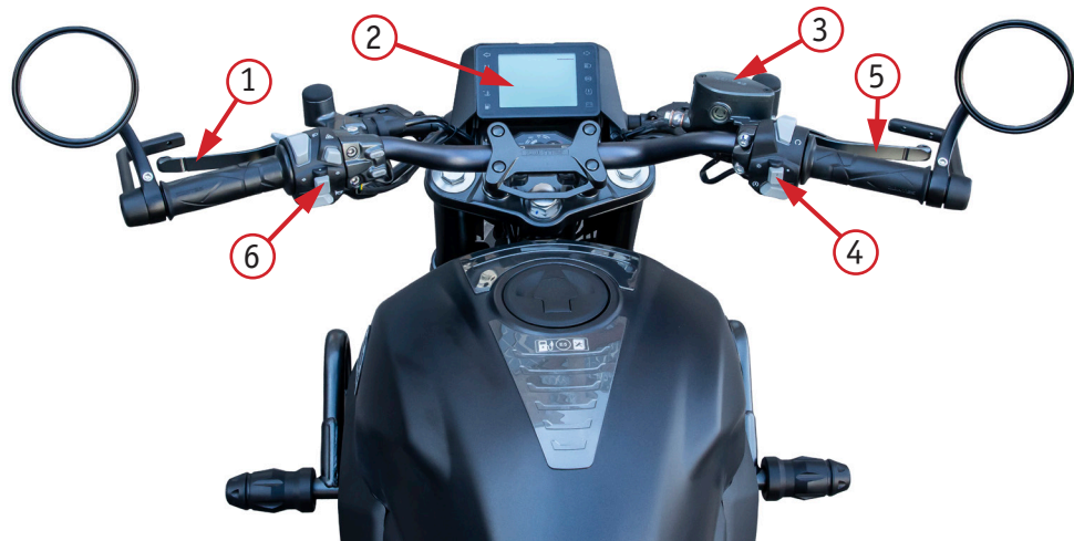
Фото 2.1. Вид руля и органов управления мотоцикла: 1 – рычаг сцепления; 2 – приборная панель; 3 – бачок для тормозной жидкости; 4 – правый комбинированный переключатель; 5 – рычаг переднего тормоза; 6 – левый комбинированный переключатель
