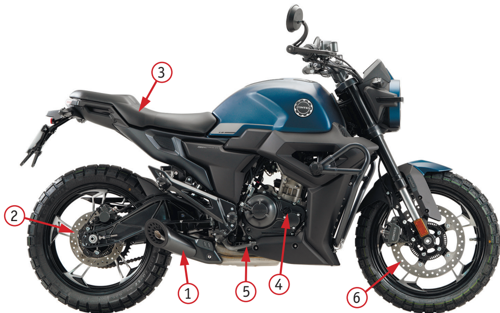
Фото 2.2. Вид справа: 1 – глушитель; 2 – задние дисковые тормоза; 3 – сиденье; 4 – заливная горловина для масла; 5 – педаль заднего тормоза; 6 – передние дисковые тормоза
