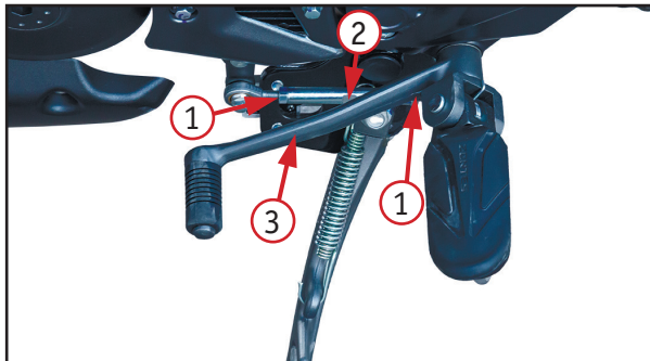
Фото 3.2. Регулировка рычага переключения передач: 1 – стопорные гайки; 2 – тяга рычага; 3 – рычаг переключения передач
