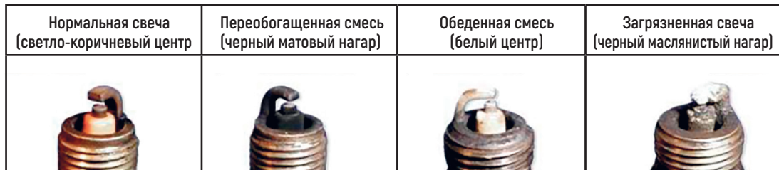
Фото 4.3. Состояния свечей зажигания
