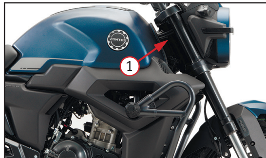
Фото 1.2 Идентификационный код транспортного средства (VIN) – 1 нанесен на правой стороне мотоцикла на раме
