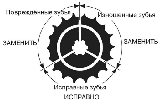
Рисунок 3. Вид зубьев звездочки
