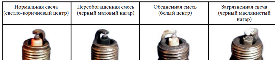
Фото 5.4. Состояния свечей зажигания
