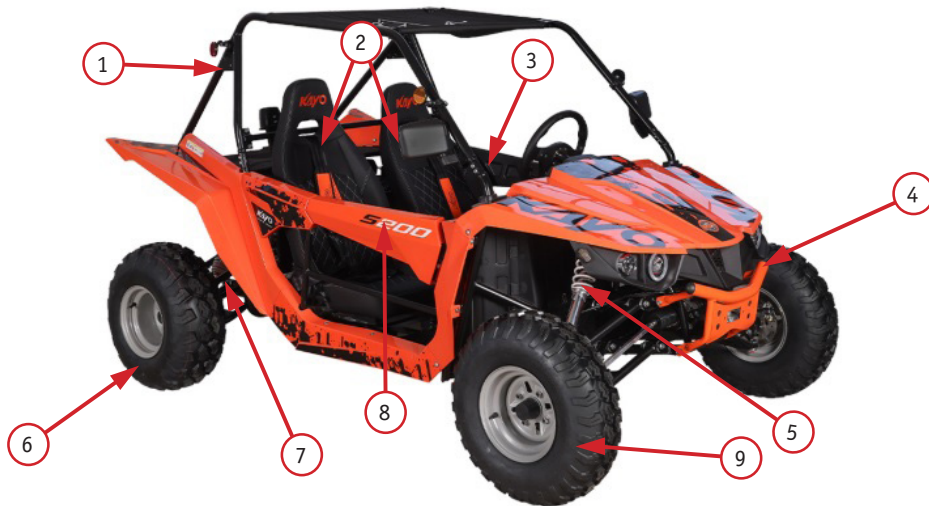
Фото 2.1. Левая сторона квадрицикла: 1 – верхние защитные дуги; 2 – сиденья; 3 – боковая водительская дверь; 4 – бампер; 5 – передний амортизатор; 6 – заднее колесо; 7 – задний амортизатор; 8 – боковая пассажирская дверь; 9 – переднее колесо
