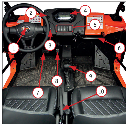
Фото 2.2. Кабина квадрицикла: 1 – руль водителя; 2 – рычаг обогащения топливной смеси; 3 – замок зажигания; 4 – приборная панель; 5 – блок переключателей электрических потребителей; 6 – поручень пассажира; 7 – педаль тормоза; 8 – педаль газа; 9 – рычаг переключения передач; 10 – рычаг ручного тормоза
