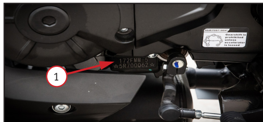
Фото 1.2. Слева на картере нанесен серийный номер двигателя 1
