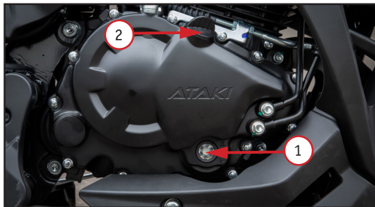
Фото 5.2.1. Контроль уровня масла для модели BATLLO: 1 – смотровое окно; 2 – крышка заливной горловины
