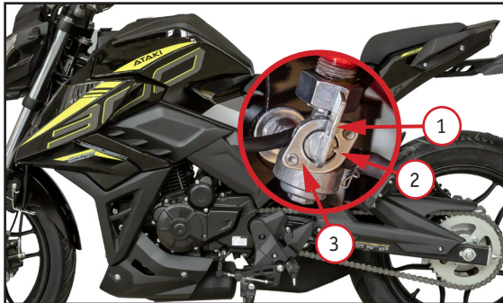
Фото 3.1 Топливный кран: 1 – положение «ОТКРЫТ»; 2 – положение «ЗАКРЫТ»; 3 – положение «РЕЗЕРВ»
