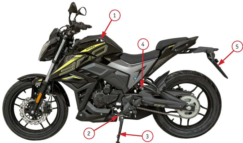
Фото 2.3. Вид слева: 1 – топливный бак; 2 – рычаг переключения передач; 3 – боковая подножка мотоцикла; 4 – задний амортизатор; 5 – крепление номерного знака
