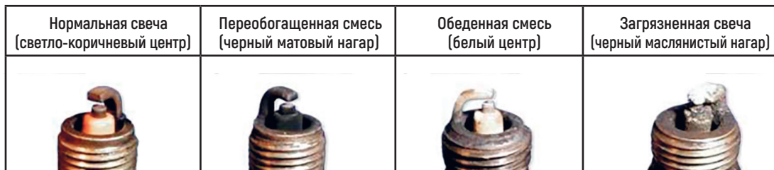
Фото 5.9. Состояния свечи зажигания
