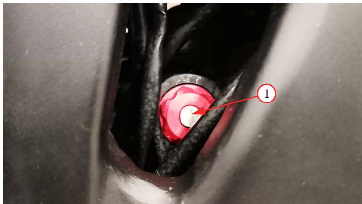
Фото 2.18. Регулировочный винт 1 сжатия пружины заднего амортизатора
