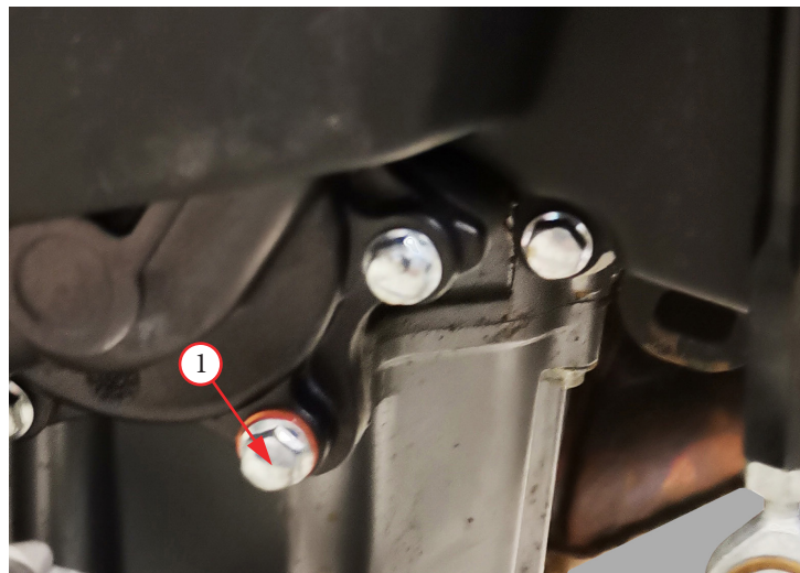
Фото 4.10. Замена охлаждающей жидкости: 1 – болт слива
