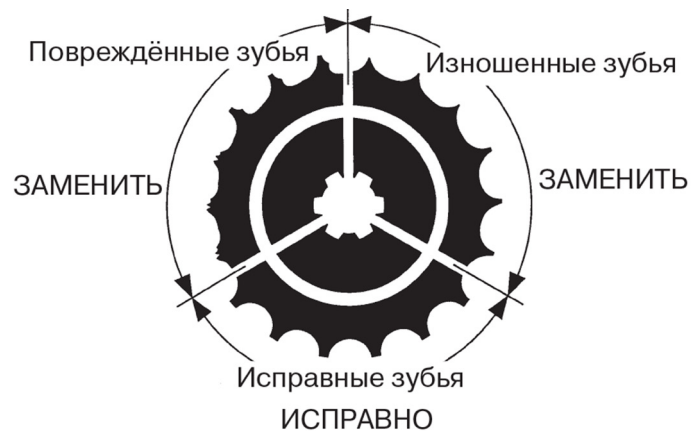
Рисунок 5. Износ звезд
