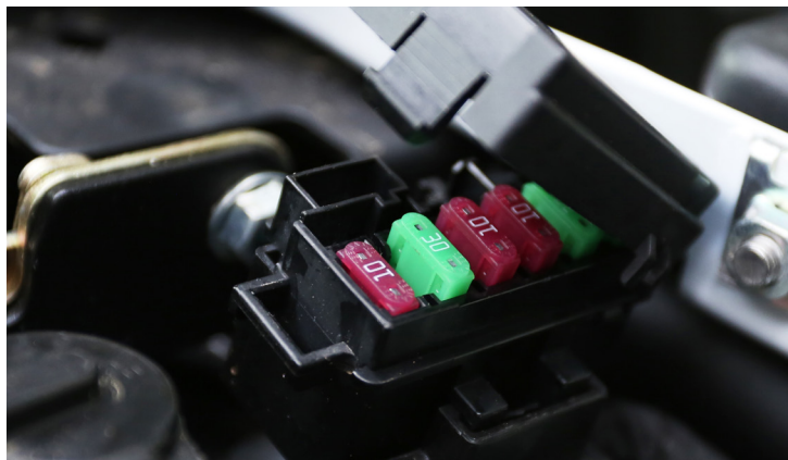
Фото 4.14. Блок с предохранителями
