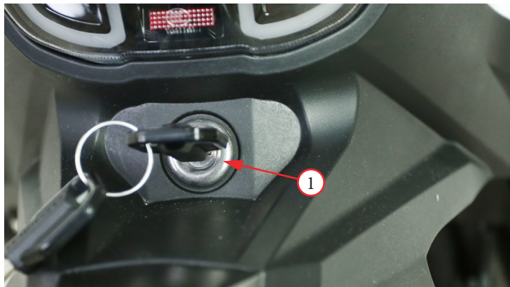
Фото 4. Снятие сидений: 1 – замок разблокировки сиденья пассажира; 2 – болты крепления сиденья водителя
