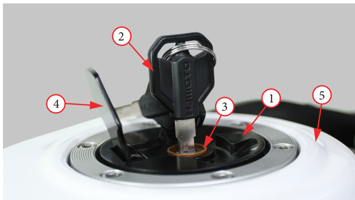
Фото 3.2. Крышка топливного бака: 1 – крышка бака; 2 – ключ зажигания; 3 – замок крышки; 4 – защитная створка; 5 – бак
