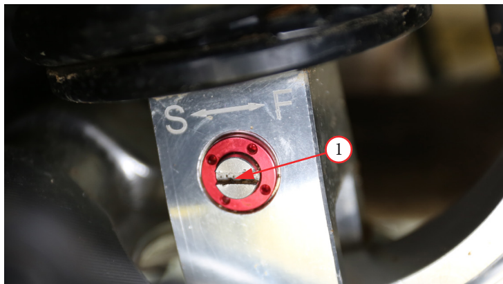
Фото 2.19. Винт регулировки отбоя – 1
