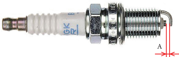
Фото 4.5. Зазор между электродами свечи зажигания – А
