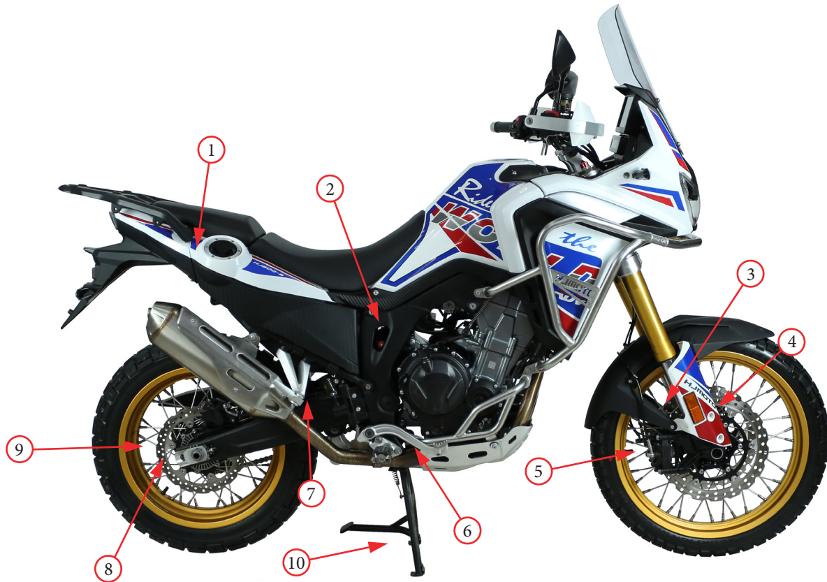
Фото 2.3. Вид справа: 1 – заливное отверстие заднего топливного бака; 2 – винт регулировки преднатяга заднего амортизатора; 3 – передний светоотражатель (правый); 4 – передний тормозной диск; 5 – передний тормозной суппорт; 6 – педаль тормоза; 7 – главный задний тормозной цилиндр; 8 – натяжитель цепи привода (правый); 9 – задний тормозной диск; 10 – центральная подставка
