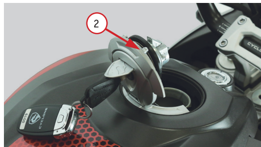
Фото 2.5. Топливный бак: 1 – защитная створка крышки; 2 – крышка бака
