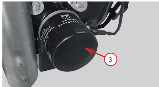
Фото 5.6. Замена масляного фильтра 3
