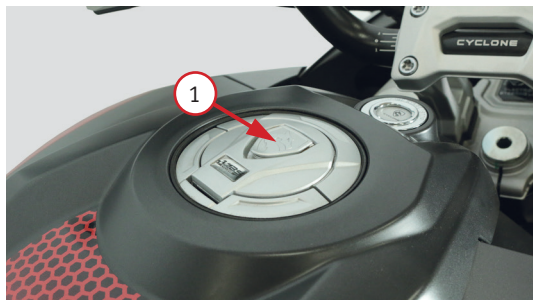
Фото 2.5. Топливный бак: 1 – защитная створка крышки; 2 – крышка бака
