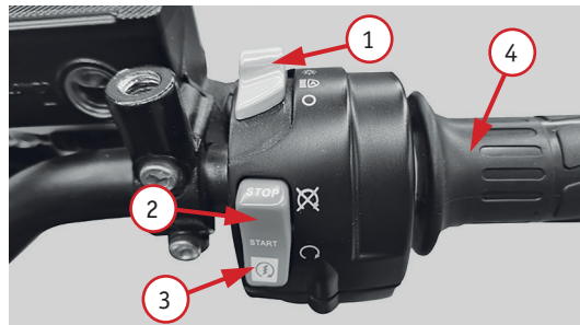
Фото 2.4. Правый комбинированный переключатель: 1 – переключатель света фары (дальний/ближний/выключен/авто); 2 – переключатель включения/отключения питания; 3 – электростартер; 4 – ручка газа (акселератора)
