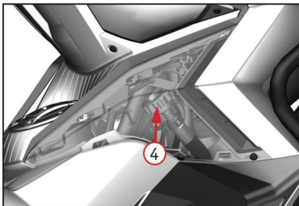
Фото 2.19. Долив охлаждающей жидкости: 1 - болты; 2 – накладка передней правой подножки; 3 – крышка бачка охлаждающей жидкости; 4 – крышка радиатора
