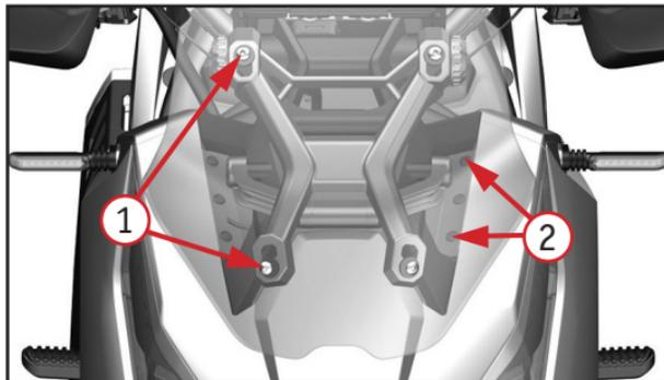
Фото 4. Снятие передней панели:
