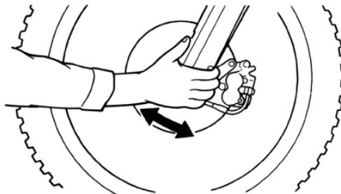
*Рисунок 1. Проверка рулевой колонки*
