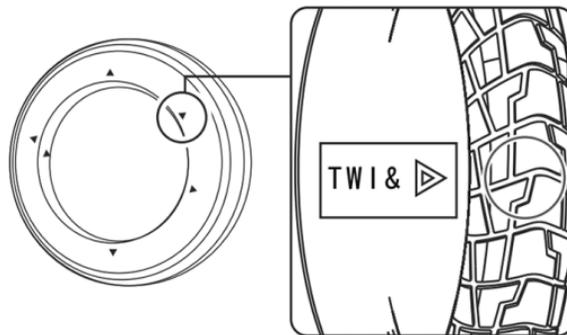
*Фото 2.23. Расположение метки износа шины*
