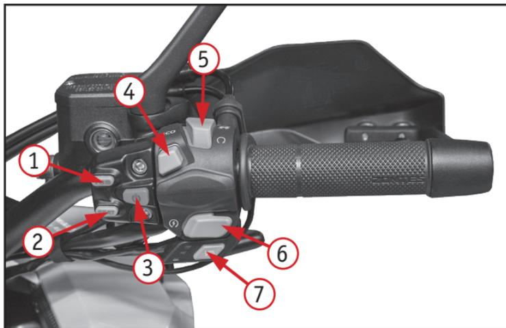
*Фото 2.5. Правый блок переключателей: 1 – кнопка «TSC»; 2 – кнопка «SEAT»; 3 – кнопка блокировки двигателя; 4 – кнопка «ECO» переключения режимов ЭКОНОМ/СПОРТ; 5 – кнопка включения цепи питания; 6 – кнопка электростартера; 7 – кнопка включения электрического подогрева ручек*
