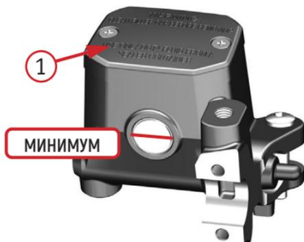
*Фото 4.9. Бачок тормозной жидкости переднего и заднего тормозов:
