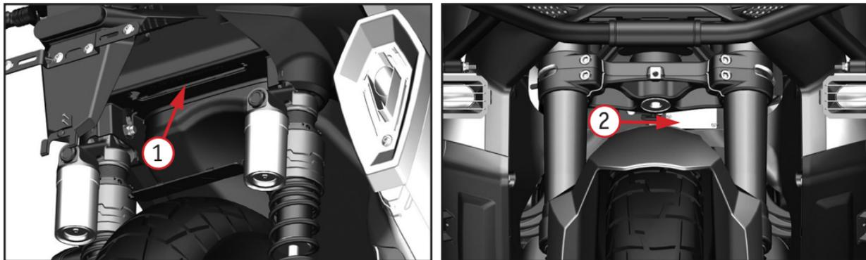
*Фото 1.1. Идентификационный номер транспортного средства – 1 (расположен в хвостовой части скутера под заглушкой); табличка с VIN номером, датой выпуска и номерами – 2 (расположена в передней части скутера)*
