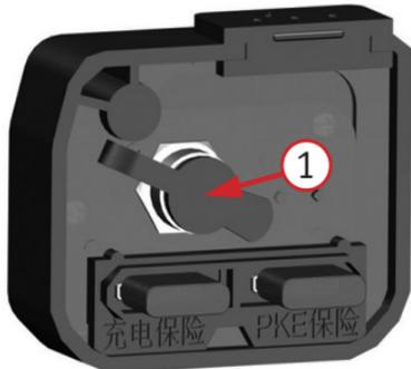
Фото 4.2 Место подключения зарядки АКБ:
