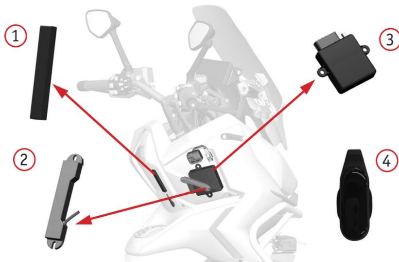
Фото 2.6. Система бесключевого доступа: 1 – приемо-передающая антенна; 2 – индуктивная антенна; 3 – блок РКЕ; 4 – активный ключ
