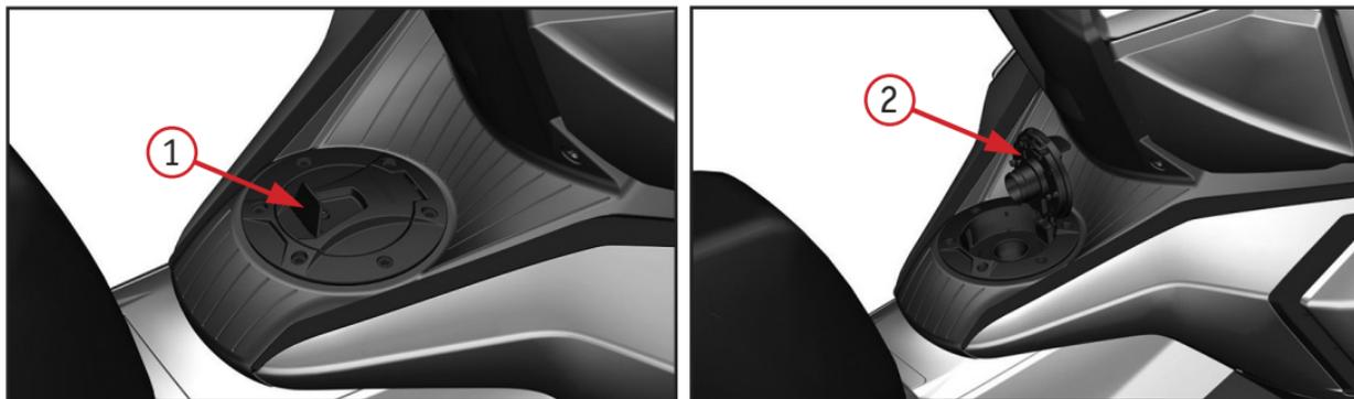
Фото 2.18. Открытие крышки топливного бака: 1 –защитная створка; 2 – крышка топливного бака
