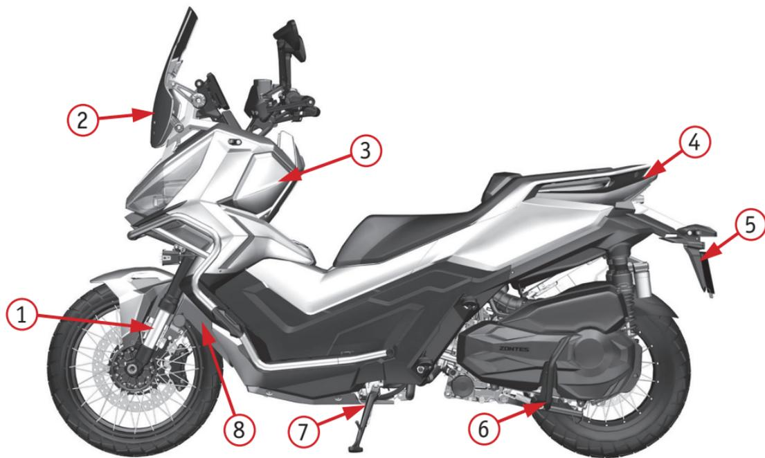
Фото 2.3 Вид слева: 1 – передние амортизаторы; 2 – ветровое стекло; 3 – левый ящик; 4 – задний фонарь; 5 – заднее крыло; 6 – центральная подставка скутера; 7 – боковая подставка; 8 – переднее крыло
