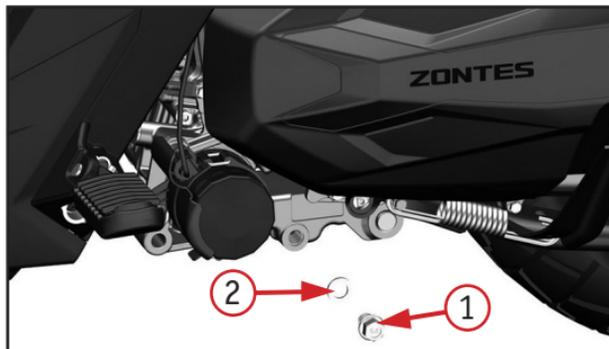
Фото 4.6. Слив моторного масла: 1 – сливной болт;
