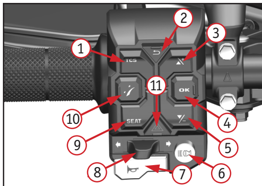
Фото 2.4. Левый блок переключателей: 1 – кнопка «TSC»; 2 – кнопка возврата/выхода; 3 – правый селектор; 4 – кнопка «OK»; 5 - левый селектор; 6 – переключатель противотуманных фар; 7 – кнопка звукового сигнала; 8 – переключатель указателей поворотов; 9 – кнопка «SEAT»; 10 – кнопка управления ветровым стеклом; 11 – кнопка включения аварийной сигнализации; 12 – переключатель режима света фары (дальний/ближний/при обгоне)
