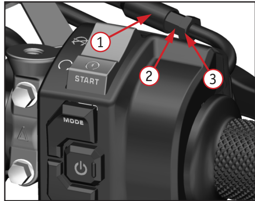
Фото 2.19. Регулировка троса газа: 1 – защитный колпачок; 2 – регулировочная гайка; 3 – стопорная гайка
