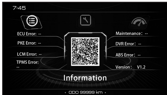
Фото 2.13. Панель с информацией о неисправностях
