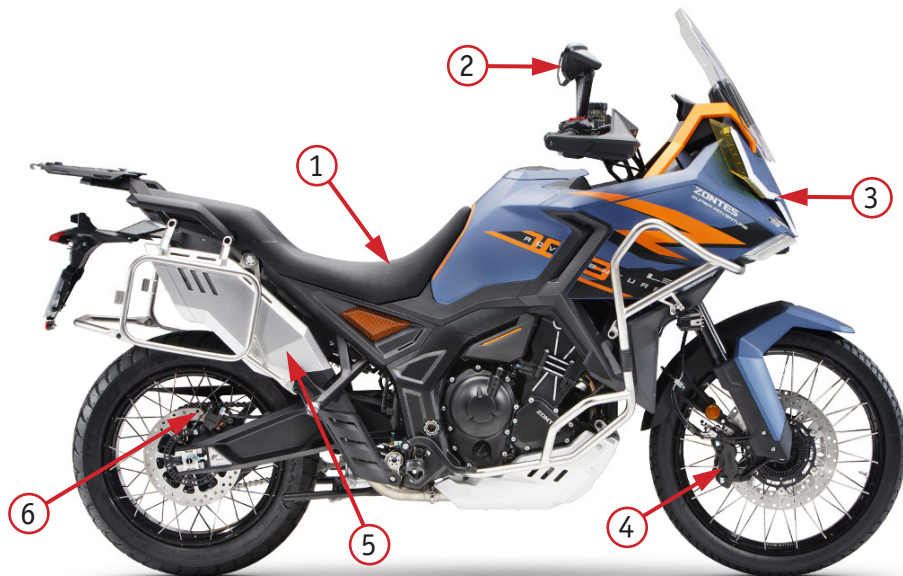
Фото 2.2. Вид справа: 1 – сиденье; 2 – зеркало заднего вида; 3 – передняя фара; 4 – передний тормозной суппорт; 5 – глушитель; 6 – задний тормозной суппорт
