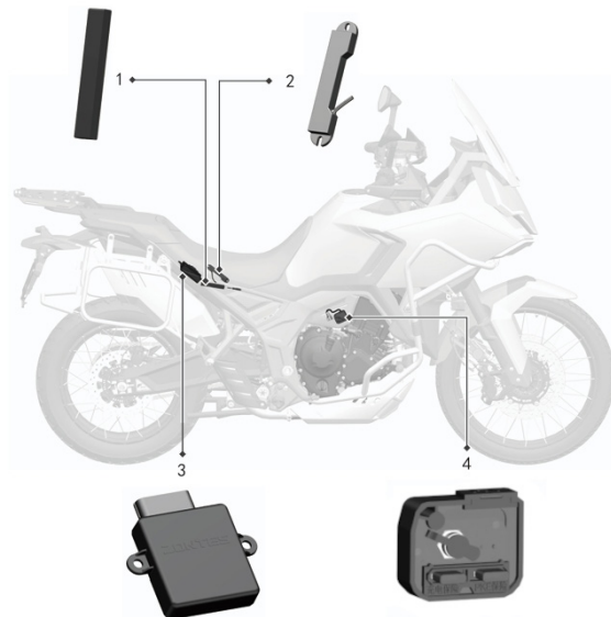
Фото 2.6. Система бесключевого доступа: 1 – приемно-передающая антенна; 2 – индуктивная антенна; 3 – блок РКЕ; 4 – порт зарядки с предохранителями
