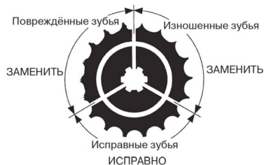
Рисунок 2. Износ звезд
