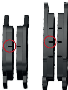
Фото 4.10. Износ тормозных колодок «А»
