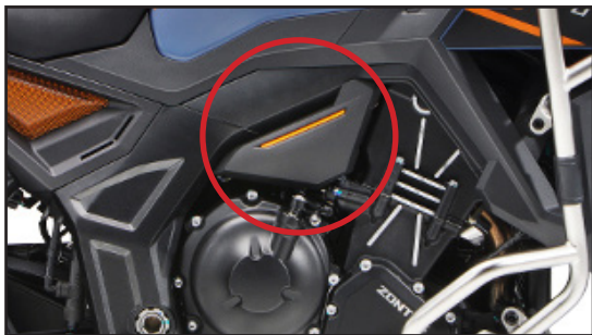
Фото 4.2 Место подключения зарядки АКБ: 1 – разъем зарядки
