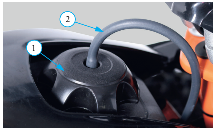
Фото 5.1. Крышка топливного бака - 1; трубка сапуна – 2
