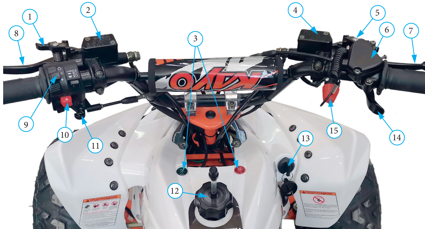
Фото 2.2. Приборы и органы управления квадрицикла (вариант): 1 - фиксатор стояночного заднего тормоза; 2 - бачок заднего тормоза; 3 - индикаторы (либо приборная панель); 4 - бачок переднего тормоза; 5 - фиксатор стояночного переднего тормоза; 6 - узел акселератора; 7 - рычаг переднего тормоза; 8 - рычаг заднего тормоза (либо рычаг сцепления для некоторых моделей); 9 - клавиша включения/выключения света; 10 - кнопка электростартера (вкл./выкл. двигателя); 11 - рычаг обогащения смеси (для модели TOR на карбюраторе); 12 - крышка топливного бака с сапуном; 13 - замок зажигания; 14 - рычаг акселератора; 15 - чека аварийного выключения двигателя (для некоторых моделей)
