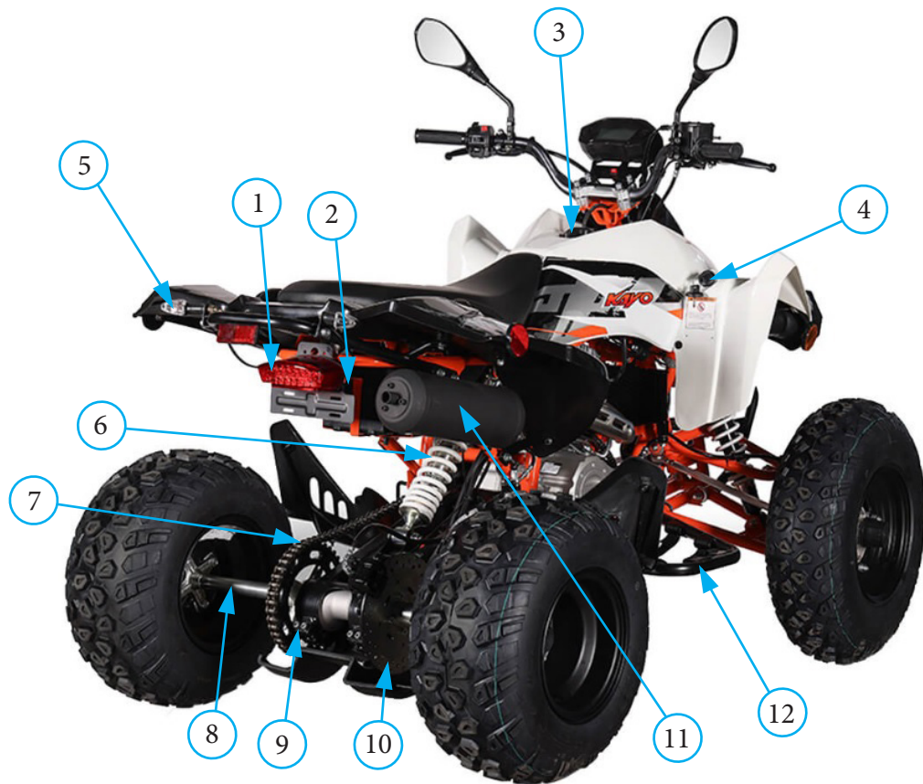
Фото 2.3. Вид с тыльной стороны квадрицикла А200: 1 – фара стоп-сигнала; 2 – аккумуляторная батарея; 3 – топливный бак; 4 – замок зажигания; 5 – задний указатель поворота; 6 – задний амортизатор; 7 – приводная цепь; 8 – ось задних колес; 9 – ведомая звезда; 10 – задний тормозной диск; 11 – глушитель; 12 – правая подножка водителя
