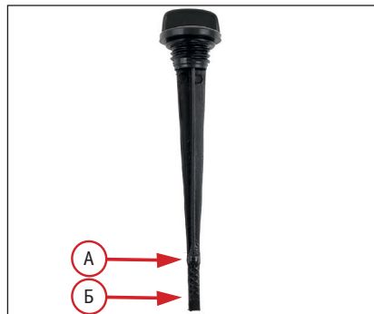
Фото 5. Крышка с щупом контроля уровня масла в двигателе 1; «А» – максимальный уровень; «Б» – минимальный уровень
