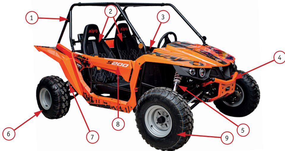
Фото 2.1. Левая сторона квадрицикла: 1 – верхние защитные дуги; 2 – сиденья; 3 – боковая водительская дверь; 4 – бампер; 5 – передний амортизатор; 6 – заднее колесо; 7 – задний амортизатор; 8 – боковая пассажирская дверь; 9 – переднее колесо
