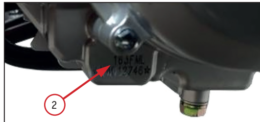
Фото 1.2. Маркировка модели и заводского номера двигателя 2
