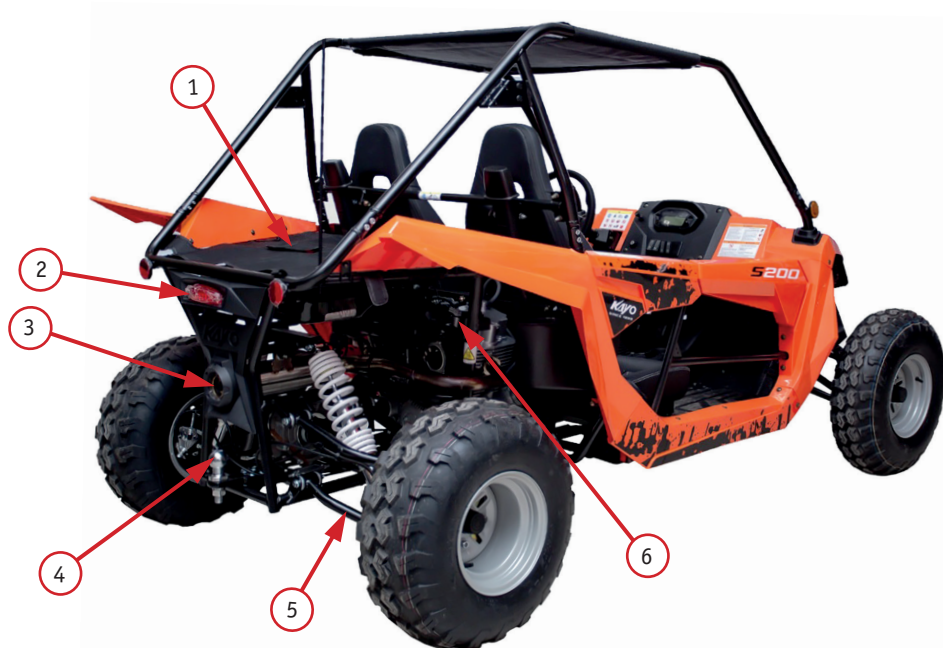
Фото 2.4. Вид квадрицикла сзади: 1 – топливный бак; 2 – фара стоп-сигнала; 3 – глушитель; 4 – прицепное устройство; 5 – рама подвески заднего колеса; 6 – двигатель
