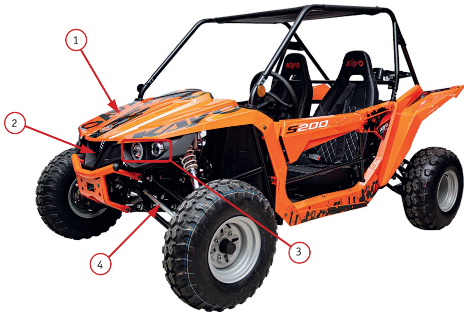
Фото 2.3. Передняя сторона квадрицикла: 1 – передний пластиковый обтекатель; 2 – решетка вентиляции; 3 – осветительные фары; 4 – рулевая тяга
