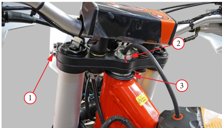
Фото 5.33. Регулировка подшипников рулевой колонки.
