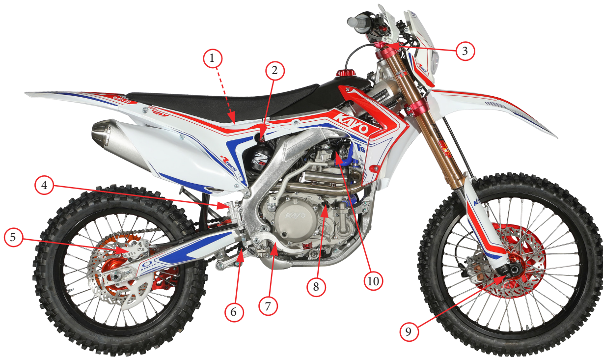
Фото 4.3. Узлы и механизмы правой стороны: 1 – аккумуляторная батарея; 2 – регулятор степени сжатия задней подвески; 3 – регулятор степени сжатия/отбоя передней подвески (в зависимости от модели); 4 – бачок жидкости заднего тормоза; 5 – суппорт заднего тормоза; 6 – регулятор степени отбоя задней подвески; 7 – педаль заднего тормоза; 8 – крышка маслозаливной горловины; 9 – регулятор степени отбоя/сжатия передней подвески (в зависимости от модели); 10 – свеча зажигания.
