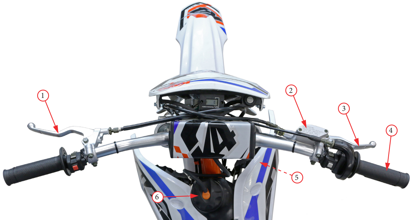
Фото 4.1. Органы и части спереди мотоцикла: 1 – рычаг сцепления; 2 – бачок жидкости переднего тормоза; 3 – рычаг переднего тормоза; 4 – ручка акселератора; 5 – пробка радиатора (для двигателей с водяным охлаждением); 6 – крышка заправочной горловины топливного бака.
