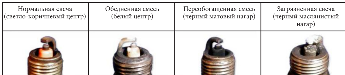
Фото 5.15. Состояния свечей зажигания.
