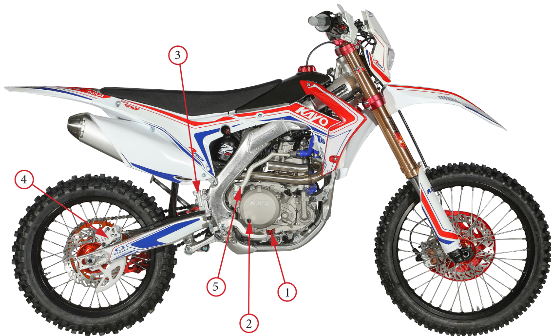
Фото 2.2. Правая сторона мотоцикла: 1 - педаль заднего тормоза; 2 - смотровое окно уровня масла; 3 - задний тормозной цилиндр; 4 - задний тормозной суппорт; 5 - рычаг кик-стартера.
