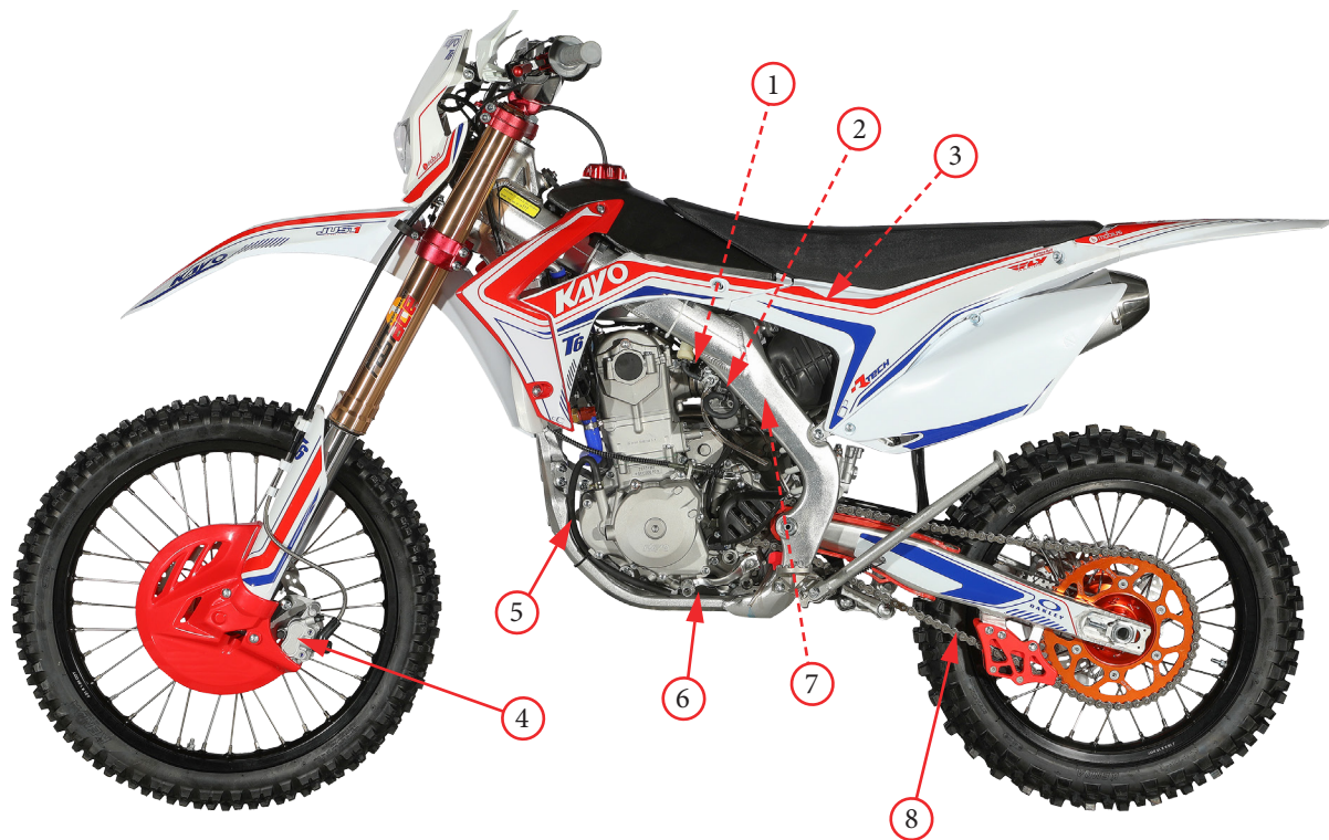
Фото 4.2. Узлы и механизмы левой стороны: 1 – рычаг обогатителя топливной смеси; 2 – регулятор частоты холостых оборотов; 3 – воздушный фильтр; 4 – суппорт переднего тормоза; 5 – пагрубок вентиляции картера; 6 – болт слива масла; 7 - регулятор пружины задней подвески; 8 – приводная цепь.
