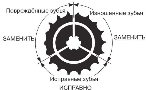
Рисунок 5.27. Вид зубьев звездочки.
