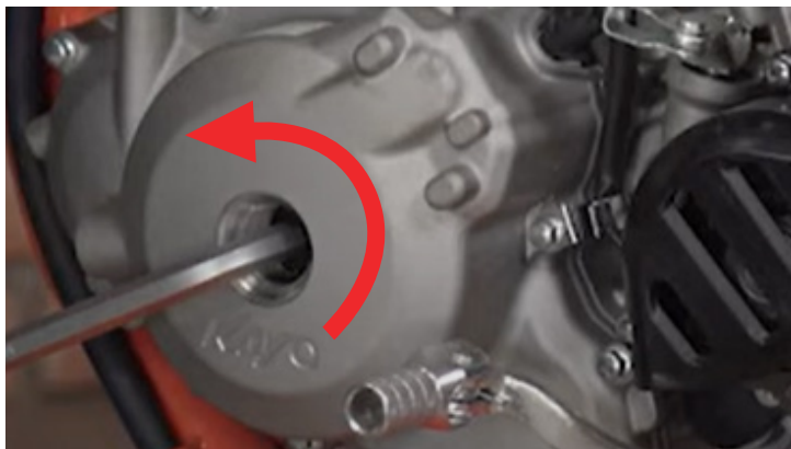
Фото 5.37. Направление вращения коленчатого вала.
