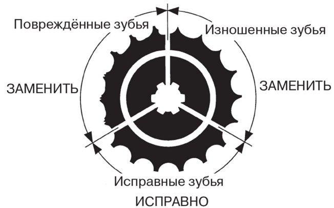
Рисунок 5.18. Вид зубьев звездочки.
