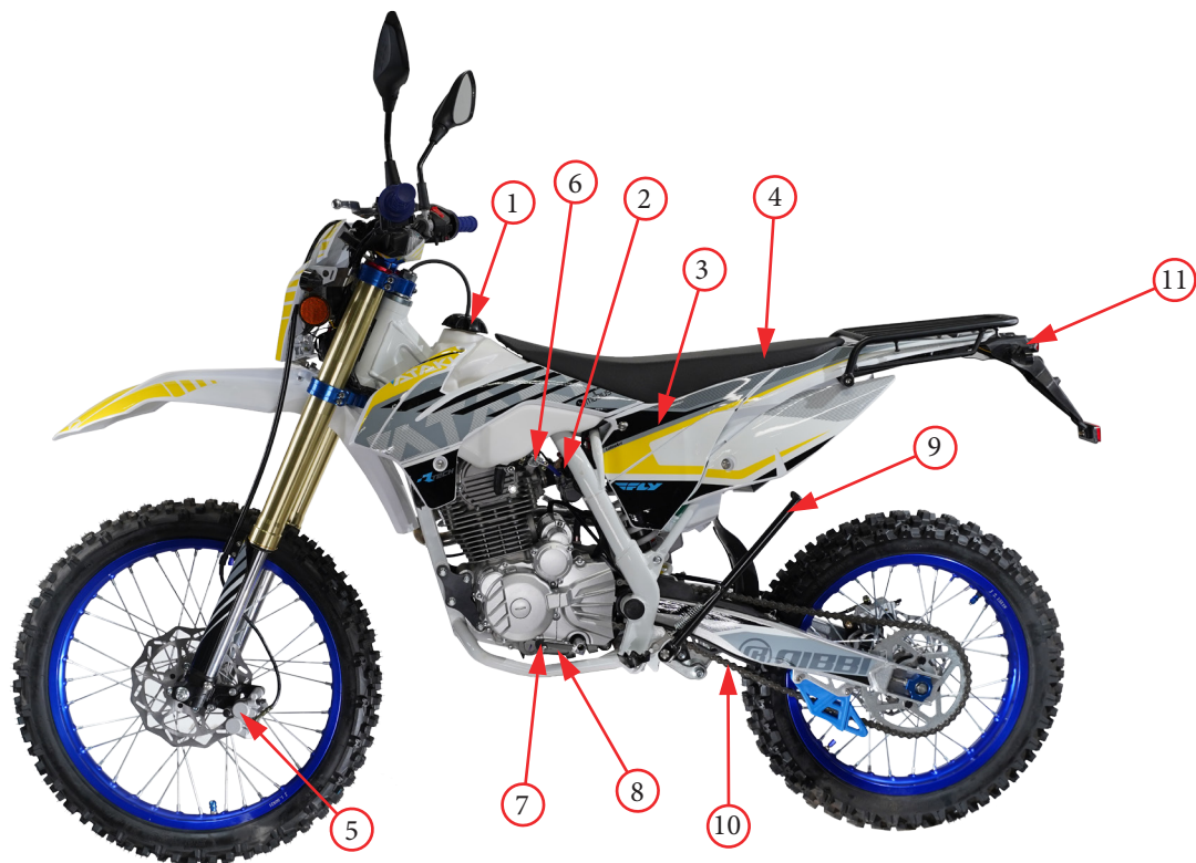
Фото 2.1. Левая сторона мотоцикла: 1 - крышка заливной горловины; 2 - карбюратор; 3 - воздушный фильтр (под сиденьем); 4 - сиденье; 5 - передний тормозной суппорт; 6 - топливный кран; 7 - рычаг переключения передач; 8 - номер двигателя; 9 - боковая подножка; 10 - приводная цепь, 11 - задние поворотные огни.
