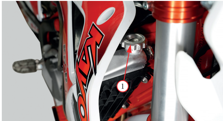
Фото 5.6. Контроль уровня охлаждающей жидкости
