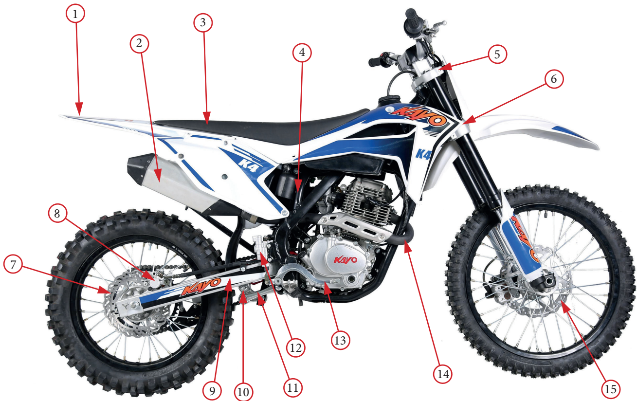
Фото 2.2. Правая сторона мотоцикла: 1 – заднее крыло; 2 – глушитель; 3 – сиденье; 4 – задний амортизатор; 5 – верхний зажим; 6 – нижний зажим; 7 – тормозной диск заднего тормоза; 8 – задний тормозной суппорт; 9 – маятник; 10 – треугольное коромысло; 11 – U-образное коромысло; 12 – задний тормозной цилиндр; 13 – педаль заднего тормоза; 14 – выхлопной патрубок; 15 – диск переднего тормоза
