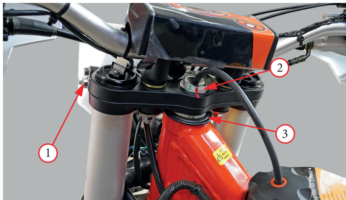
Фото 5.33. Регулировка подшипников рулевой колонки
