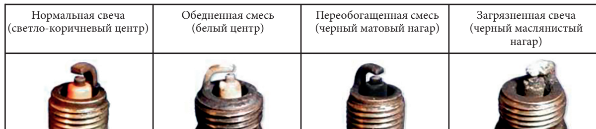
Фото 5.15. Состояния свечей зажигания
