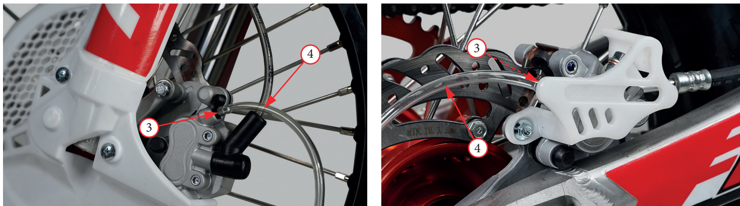
Фото 5.23. Прокачка тормозной системы
