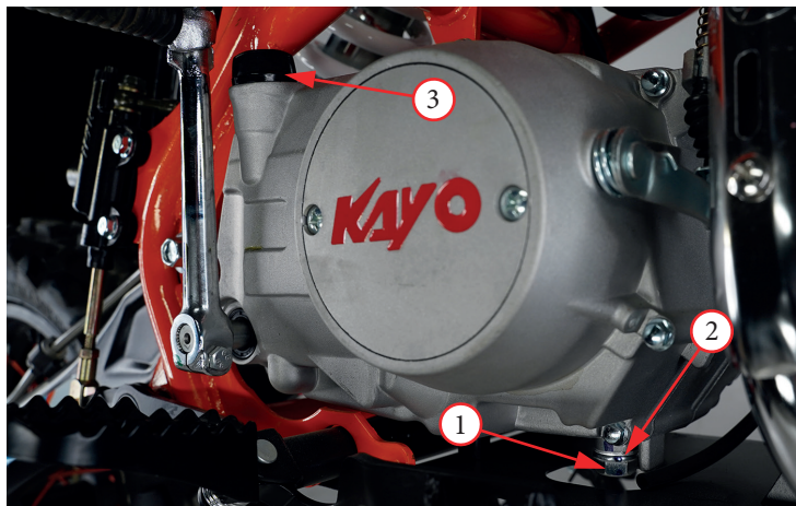
Фото 5.4. Замена масла в двигателях без фильтра
