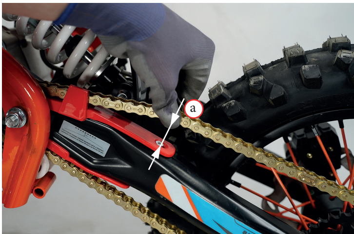
Фото 5.23. Замер провисания цепи
