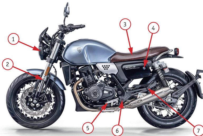
Фото 2.3. Вид слева: 1 – фара; 2 – передний амортизатор; 3 – сиденье на двух человек; 4 – фиксатор сиденья; 5 – рычаг переключения передач; 6 – левая подножка водителя; 7 – левая подножка пассажира
