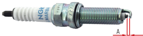
Фото 5.3. Зазор «А» между электродами свечи зажигания
