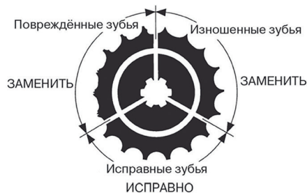
Рисунок 2. Износ звезд
