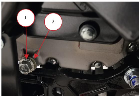
Фото 4.5. Слив моторного масла: сливной болт – 1; шайба – 2.
