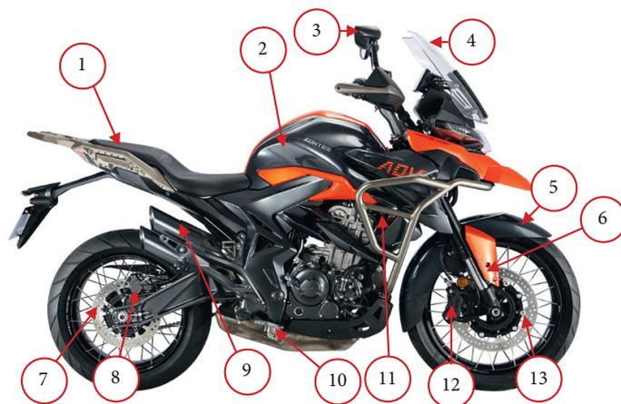
Фото 2.2. Вид справа: 1 – сиденье; 2 – топливный бак; 3 – зеркало заднего вида; 4 – ветровое стекло; 5 – крыло переднего колеса; 6 – защита правого педала; 7 – задний тормозной диск; 8 – задний тормозной суппорт; 9 – глушитель; 10 – педаль заднего тормоза; 11 – катушка зажигания; 12 – передний тормозной суппорт; 13 – передний тормозной диск.
