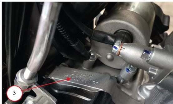
Фото 1.2. Справа на двигателе нанесен серийный номер двигателя - 3.
