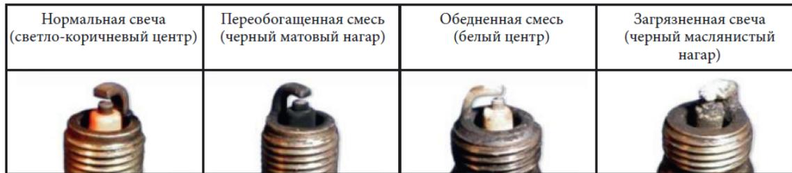
Фото 4.3. Состояния свечей зажигания.
