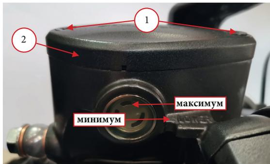
4.9.1. Бачок тормозной жидкости передних тормозов:
