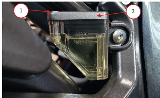
4.9.2. Бачок тормозной жидкости задних тормозов:
