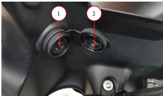
Фото 2.28. Разъем USB: 1 – разъем; 2 – защитная крышка.
