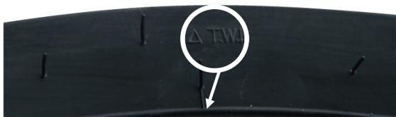
Фото 2.27. Расположение метки износа шины.
