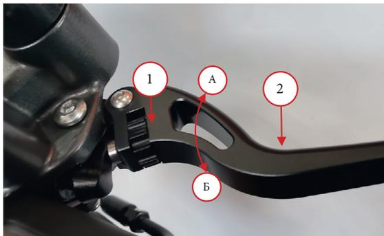
С помощью гайки регулировки 1 (Фото 2.15.) можно изменить величину натяжения троса рычага переднего тормоза. Поворачивание гайки регулировки 1 по направлению «А» происходит натяжение троса. При вращении гайки по направлению «Б» увеличивается свободный ход.
