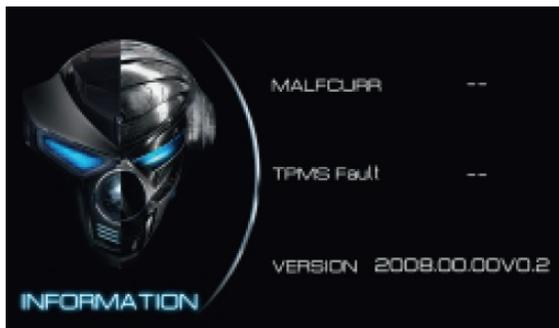
На панели (Фото 2.12.) отображается текущий код неисправности (MALFCURR), сохраненный в памяти код неисправности (TPMS) и версия программного обеспечения (VERSION).
