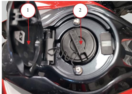
Фото 2.22. Открывание крышки топливного бака моделей ZT125-U/U1, ZT350-R/R1, ZT350-X/X1, ZT350-T, ZT350-GK, ZT350-VX, ZT350-V1 (с бесключевым доступом): «FUEL» - кнопка открытия внешней откидной крышки; 1 - внешняя защитная крышка; 2 - крышка топливного бака.
