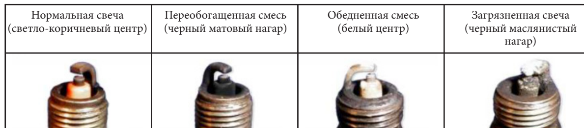
Фото 5.12. Состояния свечи зажигания.
