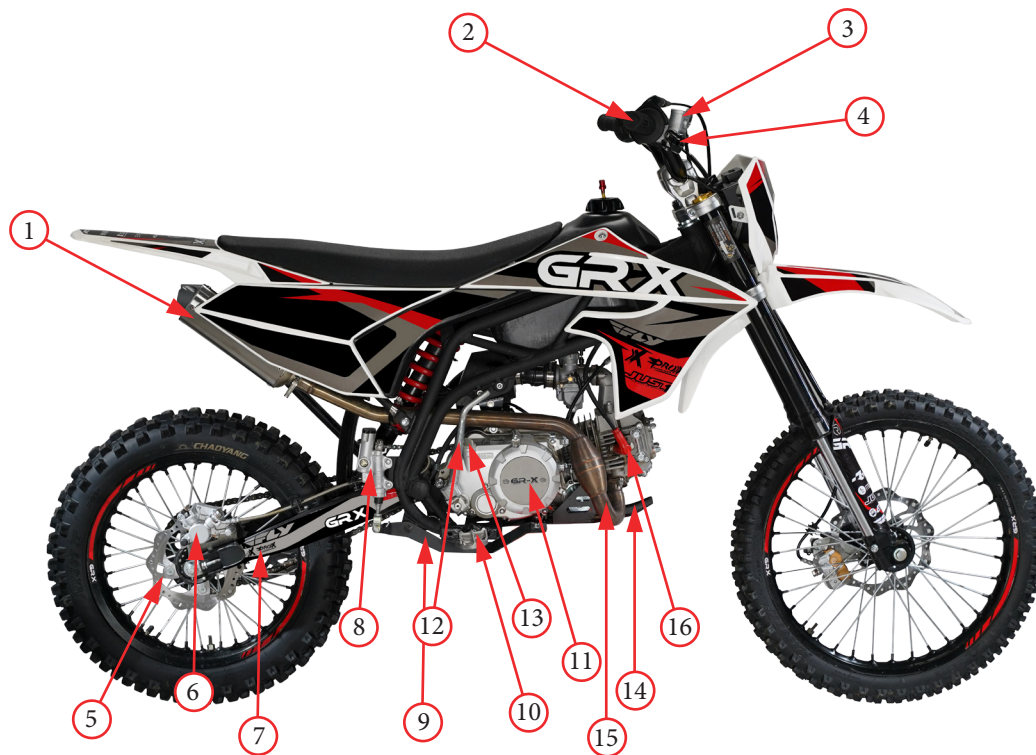
Фото 2.2. Правая сторона питбайка: 1 - глушитель; 2 - рукоятка акселератора; 3 - бачок переднего тормоза; 4 - рычаг переднего тормоза; 5 - диск заднего тормоза; 6 - задний тормозной суппорт; 7 - маятник; 8 - бачок заднего тормоза; 9 - рычаг заднего тормоза; 10 - правая подножка водителя; 11 - правая крышка картера; 12 - рычаг кик-стартера; 13 - крышка маслозаливной горловины; 14 - защита двигателя; 15 - выхлопной патрубков; 16 - свечной колпачок.
