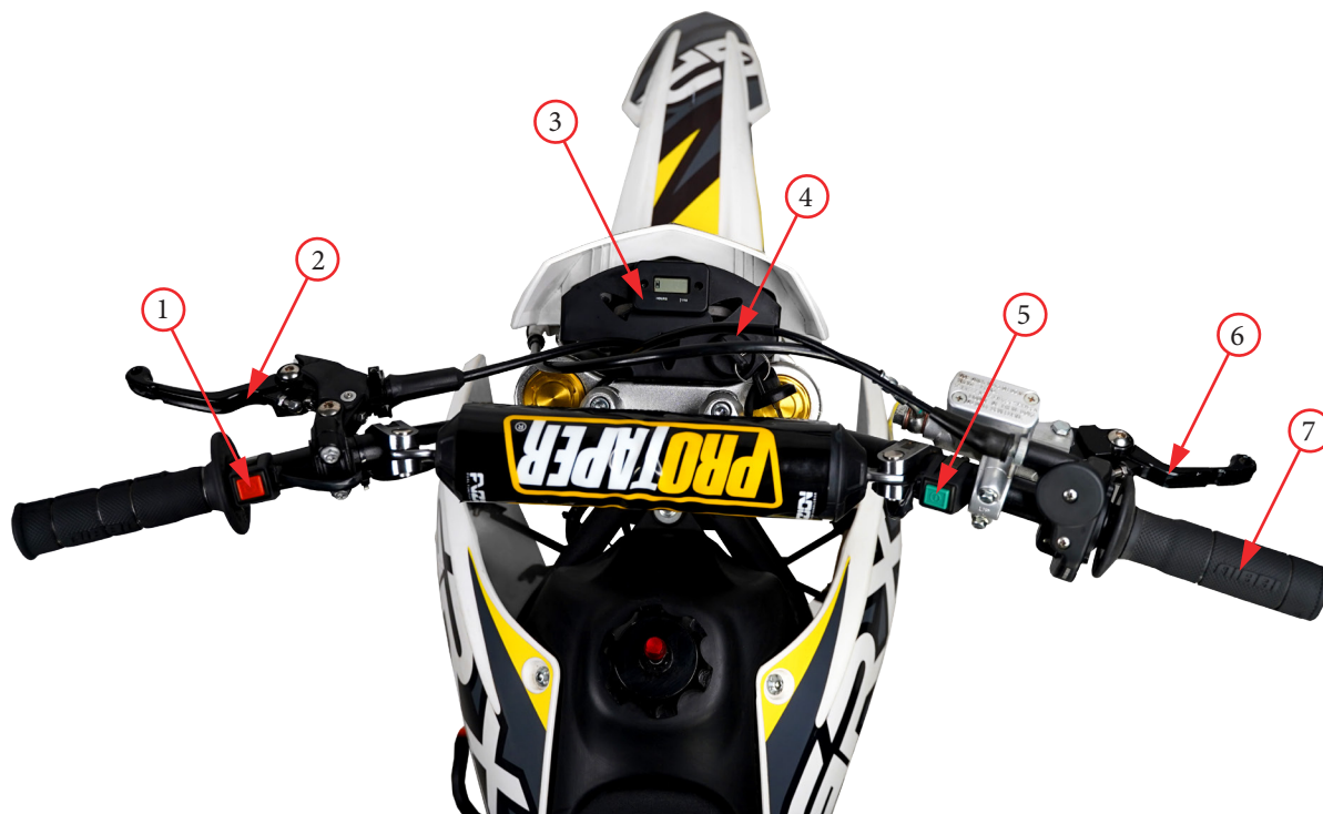
Фото 2.3. Приборы и органы управления спереди питбайка: 1 - кнопка выключения двигателя; 2 - рычаг сцепления; 3 - счетчик моточасов (приборная панель); 4- замок зажигания с включателем света; 5 - кнопка стартера; 6 - рычаг переднего тормоза; 7 - рукоятка акселератора.
