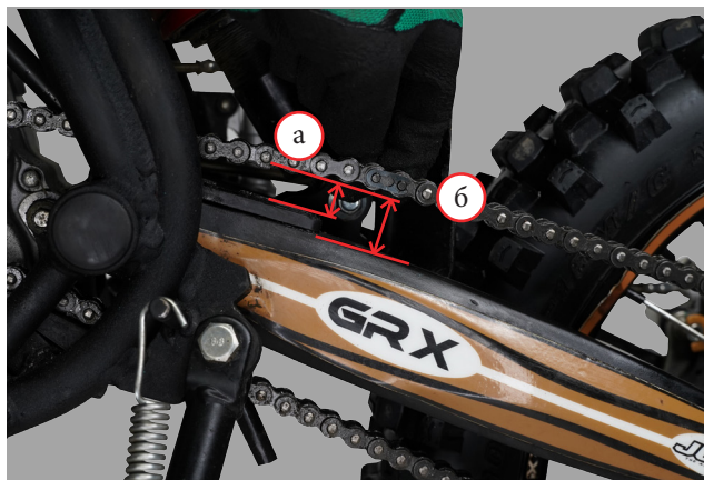
Фото 5.21. Замер провисания цепи.
