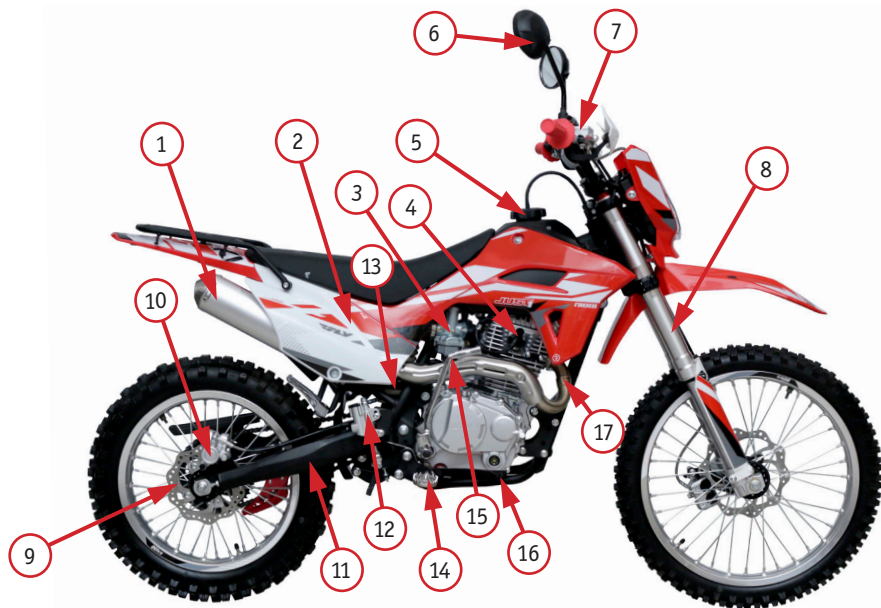
Фото 2.2.1 Вид мотоцикла JHL SX150 справа: 1 – глушитель; 2 – воздушный фильтр (за обвесом); 3 – карбюратор; 4 – свечной колпачок; 5 – крышка топливного бака; 6 – зеркало заднего вида; 7 – передний тормозной бачок; 8 – передний амортизатор; 9 – задний тормозной диск; 10 – задний тормозной суппорт; 11 – маятник; 12 – задний тормозной цилиндр; 13 – задний амортизатор; 14 – правая подножка; 15 – кик-стартер; 16 – рычаг заднего тормоза; 17 – выхлопной патрубок
