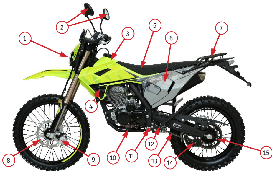
Фото 2.1 Вид мотоцикла JHL S004 300 (с ПТС) слева: 1 – фара; 2 – зеркала заднего вида; 3 – топливный бак; 4 – топливный кран (под обвесом); 5 – сиденье; 6 – воздушный фильтр (за обвесом); 7 – задний багажник; 8 – передний тормозной диск; 9 – передний тормозной суппорт; 10 – рычаг переключения передач; 11 – левая подножка; 12 – боковая подставка; 13 – приводная цепь; 14 – уловитель цепи; 15 – задняя звездочка
