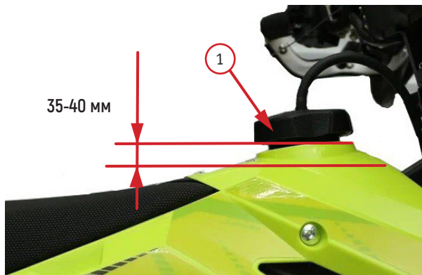
Фото 5.1. Уровень заправки топливом: 1 – крышка топливного бака
