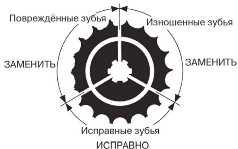
Рисунок 3. Вид зубьев звездочки
