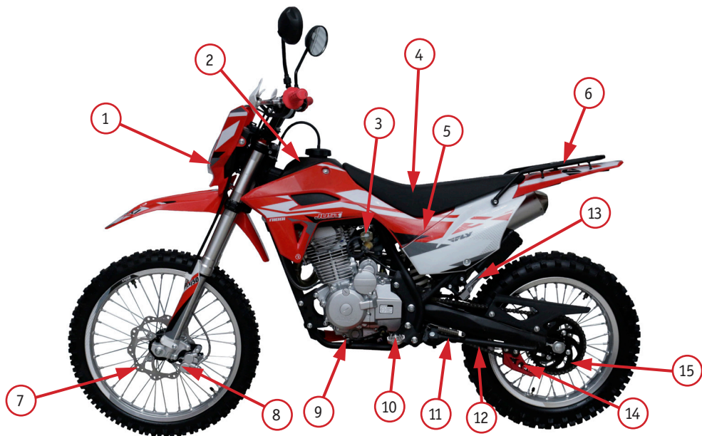
Фото 2.1.1 Вид мотоцикла JHL SX150 слева: 1 – фара; 2 – топливный бак; 3 – топливный кран; 4 – сиденье; 5 – аккумуляторная батарея (за обвесом); 6 – задний багажник; 7 – передний тормозной диск; 8 – передний тормозной суппорт; 9 – рычаг переключения передач; 10 – левая подножка водителя; 11 – боковая подставка; 12 – приводная цепь; 13 – левая подножка пассажира; 14 – уловитель цепи; 15 – задняя звездочка
