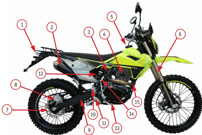
Фото 2.2. Вид мотоцикла JHL S004 300 (с ПТС) справа: 1 – задний фонарь; 2 – глушитель; 3 – карбюратор; 4 – свечной колпачок; 5 – крышка топливного бака; 6 – передняя вилка; 7 – задний тормозной диск; 8 – задний тормозной суппорт; 9 – маятник; 10 – задний тормозной цилиндр; 11 – правая подножка водителя; 12 – задний амортизатор; 13 – педаль тормоза; 14 – кик-стартер; 15 – выхлопной патрубок
