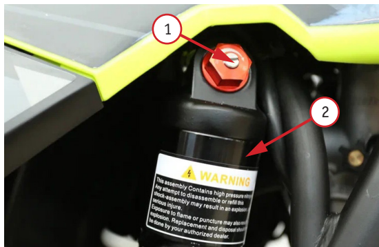
Фото 5.19. Регулятор сжатия задней подвески: 1 – регулировочный винт; 2 – резервуар
