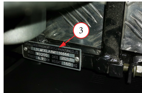
Фото 1.3 Место расположения номера VIN на модели WD150 (под сиденьем, с левой стороны рамы) – 3.
