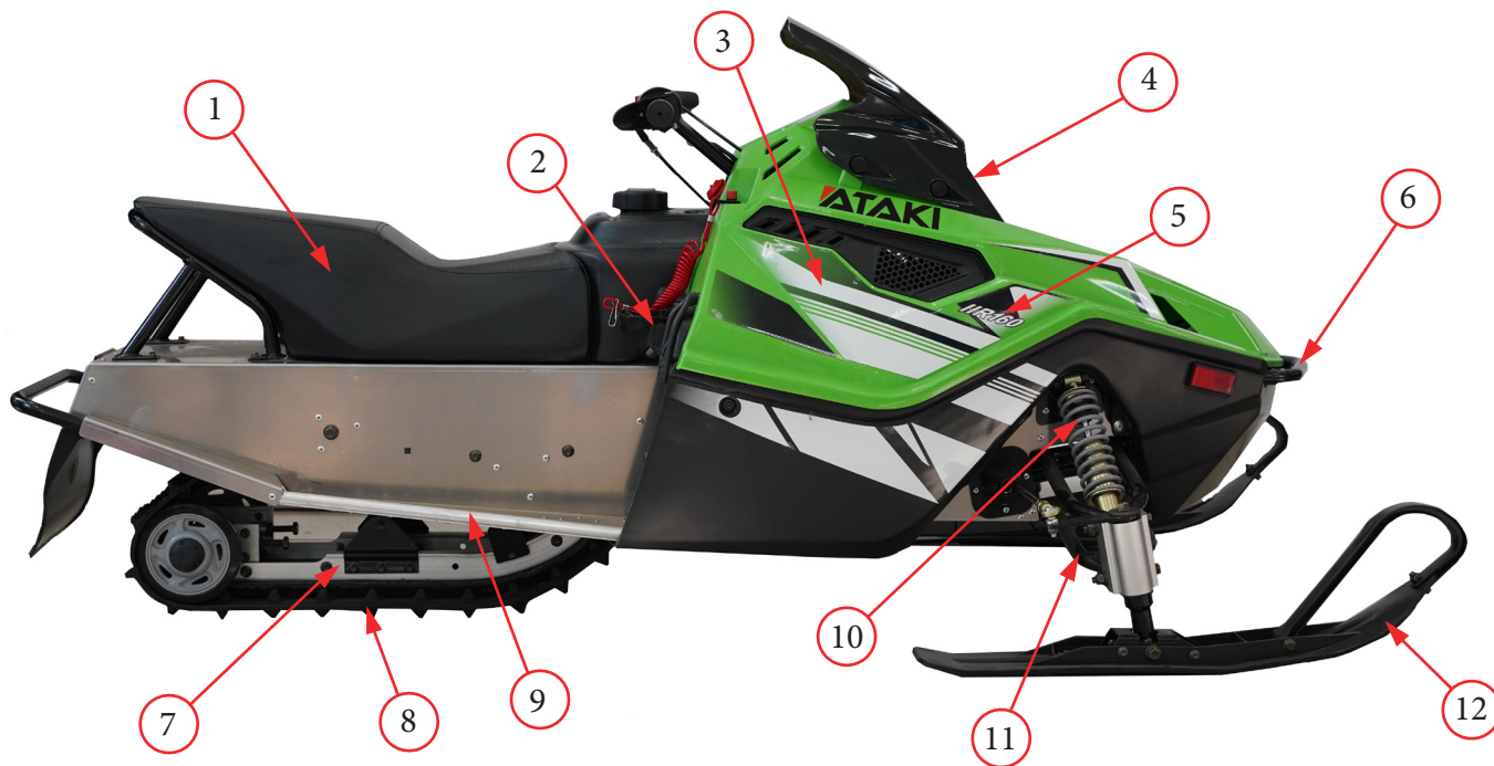
Фото 2.1.2 Узлы и части снегохода модели WD160: 1 – сиденье; 2 – рукоятка ручного запуска; 3 – карбюратор (под крышкой моторного отсека); 4 - фара; 5 – аккумулятор, предохранитель и электрические компоненты (под крышкой моторного отсека); 6 – передний бампер; 7 - узел задней подвески с роликами; 8 - резиновая гусеница; 9 – подножка водителя; 10 – амортизатор; 11 - поворотный кулак; 12 – лыжа.
