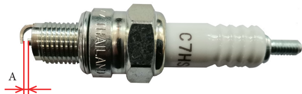
Фото 15. Зазор свечи зажигания - А.
