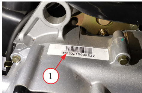
Фото 1.1 Место расположения серийного номера двигателя - 1.
