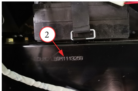
Фото 1.2 Место расположения номера VIN на модели WD160 (под крышкой моторного отсека, спереди) – 2.
