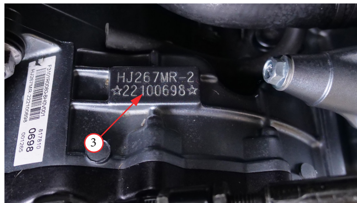
Фото 1.4. Место расположения серийного номера двигателя - 3.
