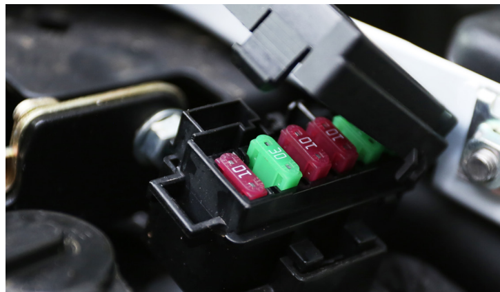
Фото 4.14. Блок с предохранителями.
