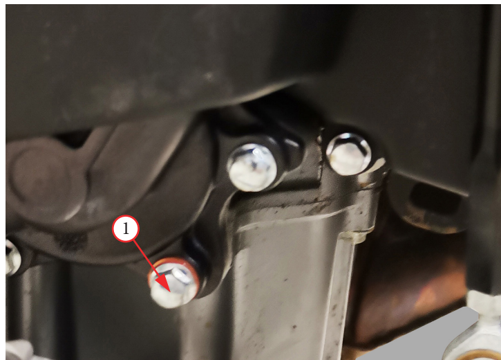
Фото 4.10. Замена охлаждающей жидкости: 1 – болт слива.
