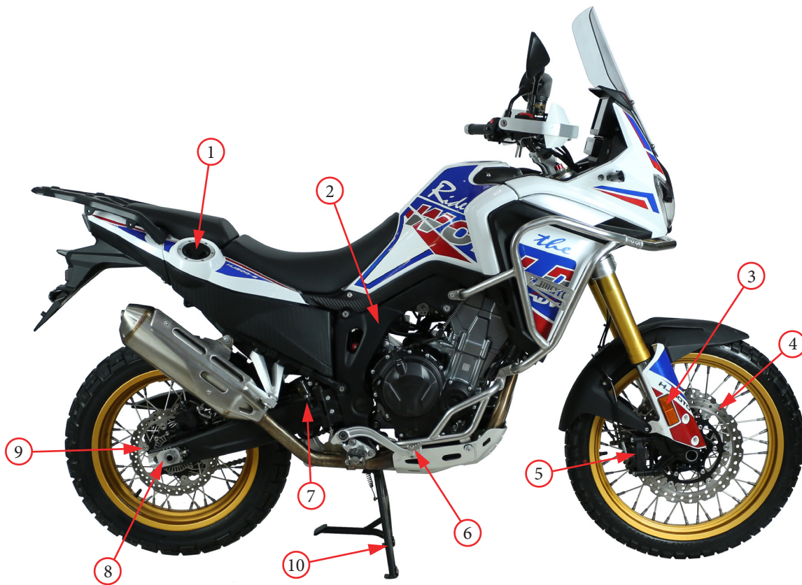
Фото 2.3. Вид справа: 1 - заливное отверстие заднего топливного бака; 2 - винт регулировки преднатяга заднего амортизатора; 3 - передний светоотражатель (правый); 4 - передний тормозной диск; 5 - передний тормозной суппорт; 6 - педаль тормоза; 7 - главный задний тормозной цилиндр; 8 - натяжитель цепи привода (правый); 9 - задний тормозной диск; 10 - центральная подставка.
