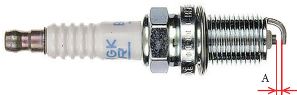
Фото 4.5. Зазор между электродами свечи зажигания - А.
