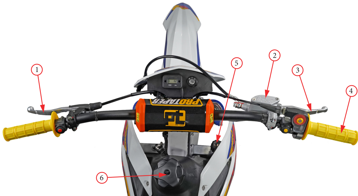
Фото 4.1. Узлы расположенные спереди: 1 - рычаг сцепления; 2 - бачок тормозной жидкости переднего тормоза; 3 - рычаг переднего тормоза; 4 - рукоятка акселератора; 5 - крышка бачка охлаждающей жидкости; 6 - крышка топливного бака.
