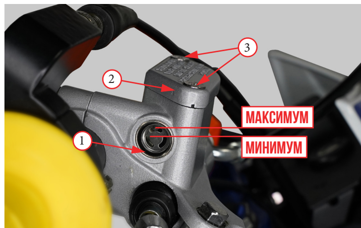
Фото 5.17. Контроль и долив тормозной жидкости
