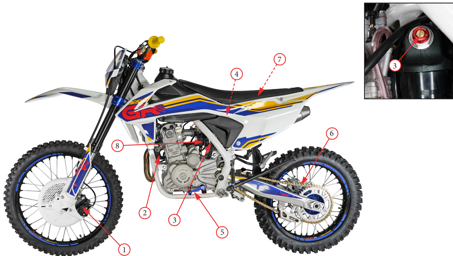
Фото 4.2. Узлы и механизмы (левая сторона): 1- суппорт переднего тормоза; 2 - патрубки радиатора; 3 - регулятор задней подвески; 4 - место воздушного фильтра (под аккумулятором); 5 - место размещения болта слива масла; 6 - приводная цепь; 7 - место размещения аккумулятора (под сиденьем); 8 - рычаг обогатителя топливной смеси.
