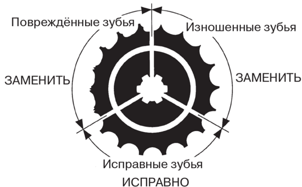
Рисунок 5.23. Вид зубьев звездочки
