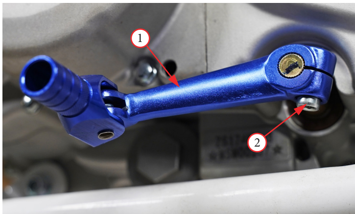
Фото 5.12. Регулировка положения рычага передач
