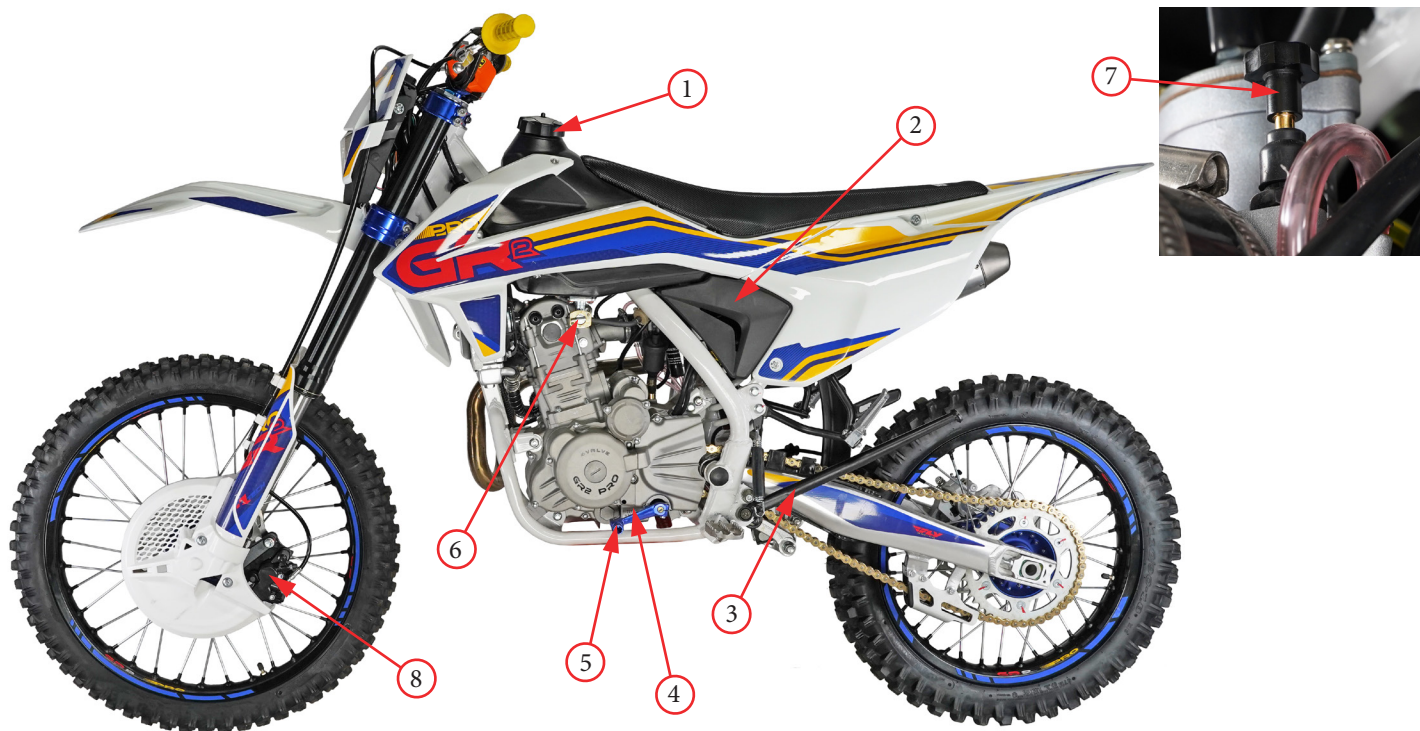
Фото 2.1. Левая сторона мотоцикла: 1 - крышка заливной горловины; 2 - воздушный фильтр (за обвесом); 3 - боковая подножка; 4 - номер двигателя; 5 - рычаг переключения передач; 6 - топливный кран; 7 - рычаг обогатителя топливной смеси; 8 - передний тормозной суппорт.
