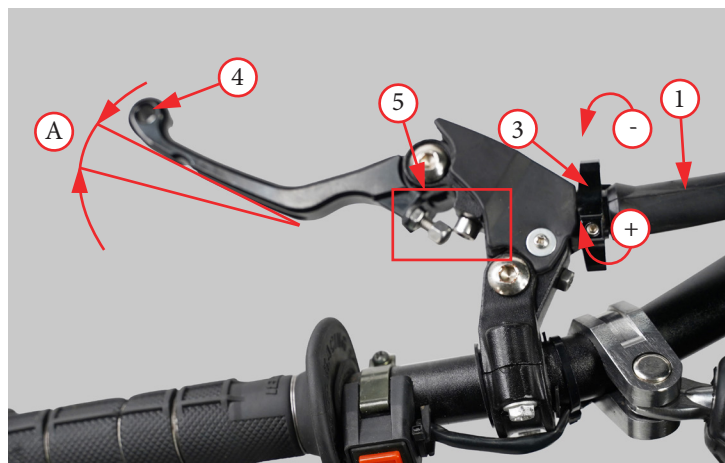
Фото 5.10. Регулировка свободного хода рычага сцепления (варианты исполнения)
