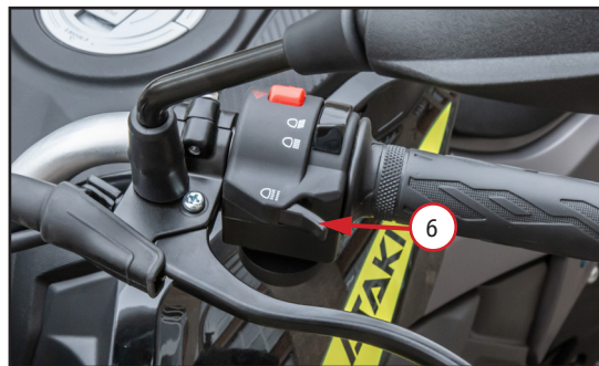
Фото 2.4.1 Левый комбинированный переключатель для моделей BATLLO, CARRERA, WEEK9: 1 – переключатель режима света фары (дальний свет / ближний свет); 2 – клавиша указателей поворота; 3 – кнопка звукового сигнала; 4 – кнопка аварийной сигнализации; 5 –рычаг воздушной заслонки (обоганитель топливной смеси) (только для модели BATLLO); 6 – кнопка включения дальнего света при обгоне
