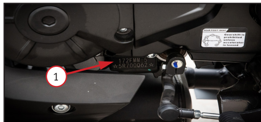
Фото 1.2. Слева на картере нанесен серийный номер двигателя 1
