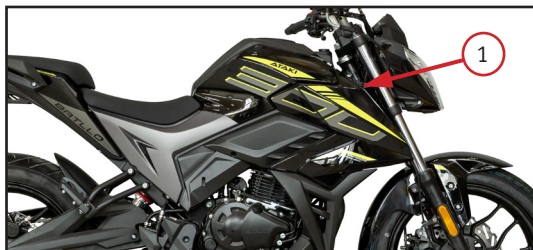
Фото 1.1. Идентификационный код транспортного средства (VIN) 1 нанесен справа на рулевом стакане
