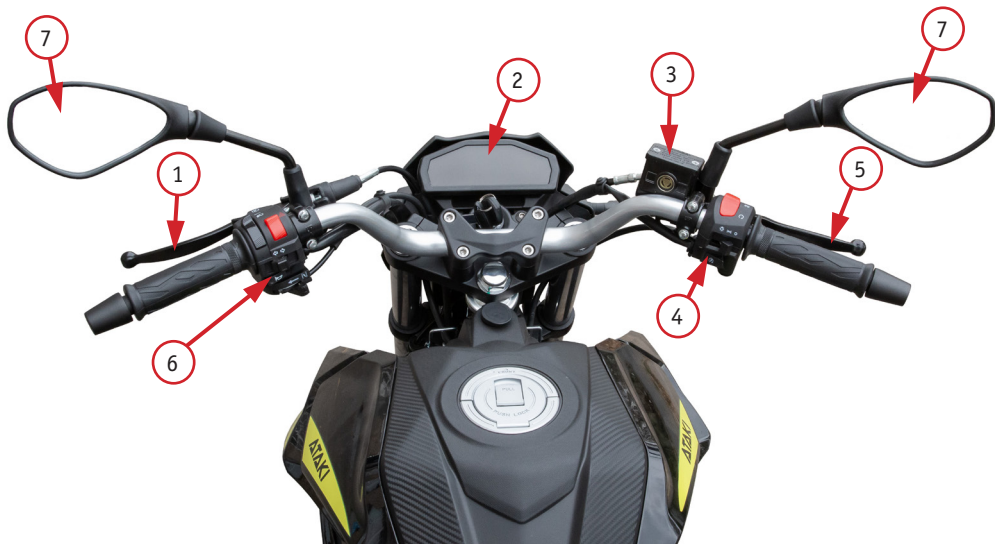
Фото 2.1. Вид руля и органов управления мотоцикла: 1 – рычаг сцепления; 2 – приборная панель; 3 – бачок для тормозной жидкости; 4 – правый комбинированный переключатель; 5 – рычаг переднего тормоза; 6 – левый комбинированный переключатель; 7 – зеркало заднего вида
