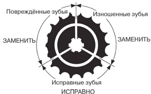
Рисунок 2. Вид зубьев звездочки
