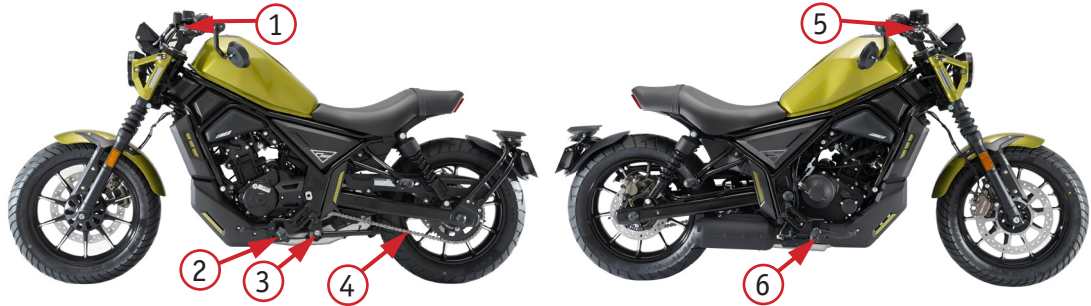
Фото 4.11. Элементы регулярной смазки: 1 – рычаг сцепления; 2 – левая подножка водителя; 3 – боковая подножка с пружиной; 4 – приводная цепь; 5 – рычаг тормоза; 6 – правая подножка водителя
