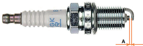
Фото 4.4. Зазор между электродами свечи зажигания
