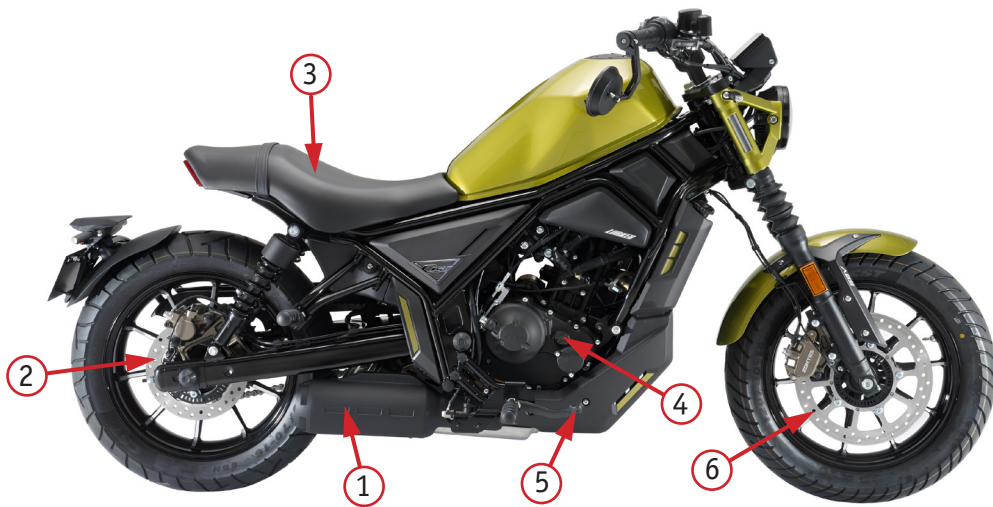
Фото 2.2. Вид справа: 1 – глушитель; 2 – задние дисковые тормоза; 3 – сиденье; 4 – заливная горловина для масла; 5 – педаль заднего тормоза; 6 – передние дисковые тормоза
