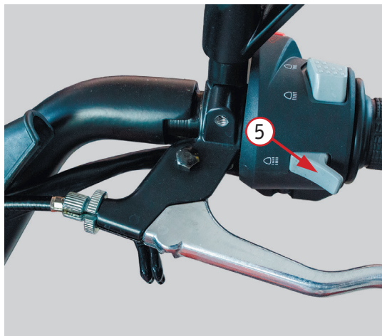
Фото 2.4.1 Левый комбинированный переключатель моделей ML800 и RL800: 1 – кнопка переключения режима света фары (дальний свет/ближний свет); 2 – переключатель указателей поворота; 3 – кнопка звукового сигнала; 4 – кнопка аварийной сигнализации; 5 – кнопка включения дальнего света при обгоне
