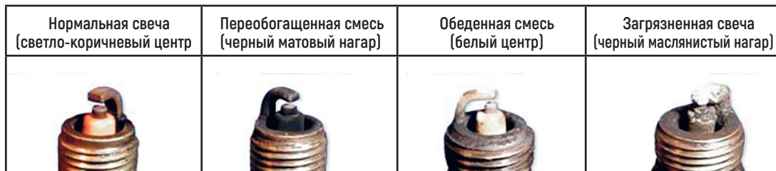
Фото 5.1. Состояния свечей зажигания
