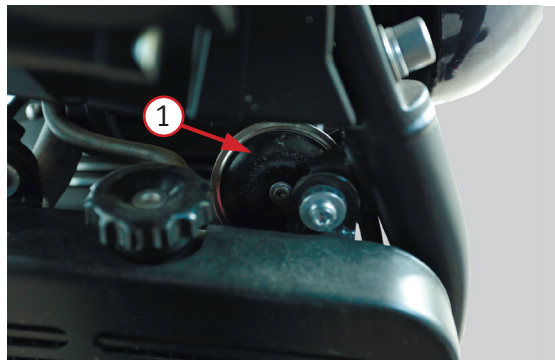
Фото 4.1 Электрический звуковой сигнал – 1
