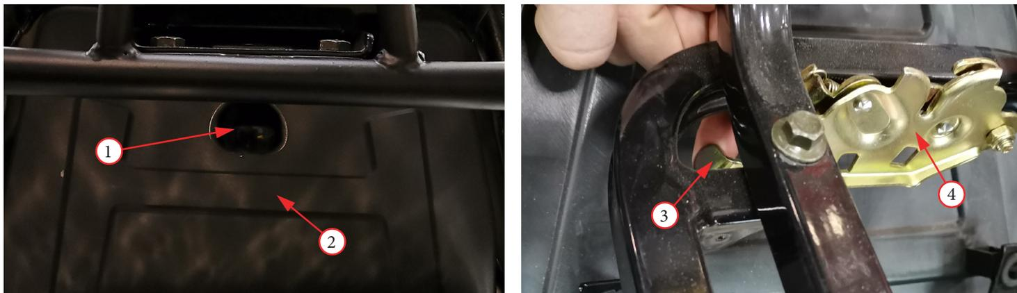
Фото 10. Снятие сиденья на модели WD150: 1 – болт; 2 – задняя крышка сиденья; 3 – рычаг фиксатора замка; 4 – замок.
