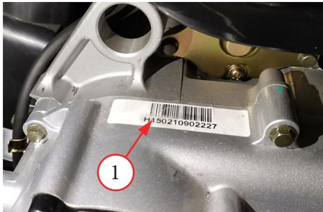
Фото 1.1 Место расположения серийного номера двигателя - 1.
