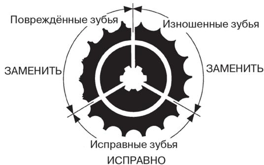
Рисунок 23. Вид зубьев звездочки.
