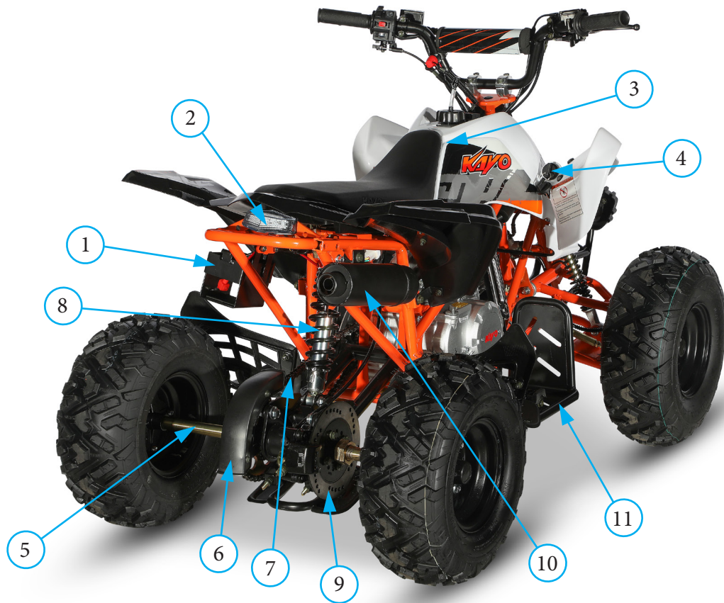
Фото 2.3. Вид с тыльной стороны транспортного средства: 1 – аккумуляторная батарея; 2 – задний фонарь; 3 – топливный бак; 4 – замок зажигания; 5 – ось задних колес; 6 – защита ведомой звезды; 7 – приводная цепь; 8 – задний амортизатор; 9 – задний тормозной диск; 10 – глушитель; 11 – правая подножка водителя
