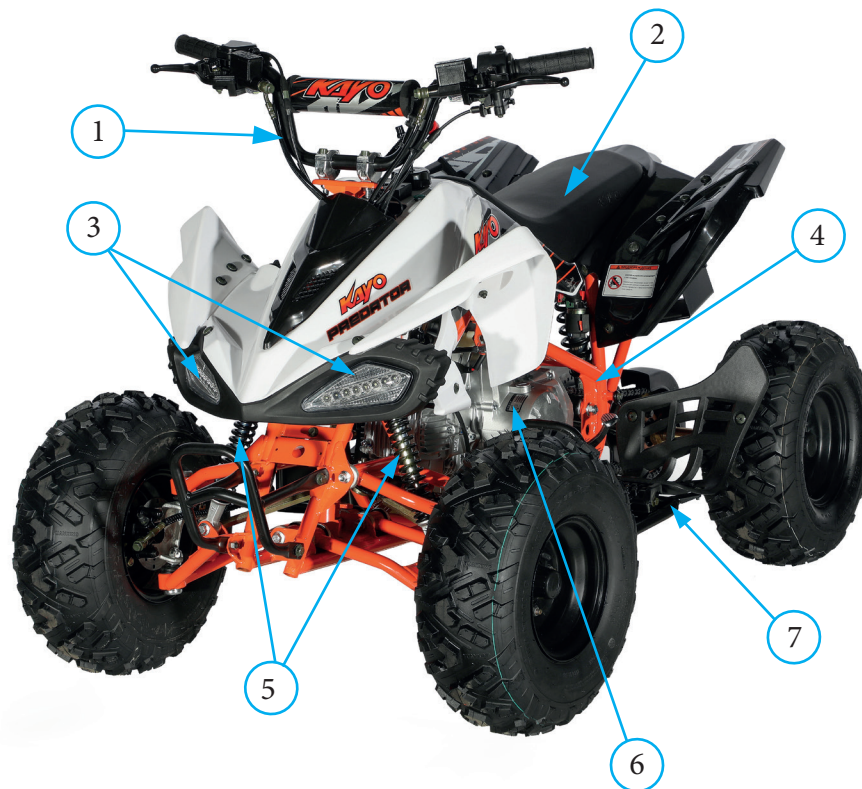
Фото 2.1. Левая сторона транспортного средства: 1 – руль с органами управления; 2 – сиденье; 3 – передние фары; 4 – рама; 5 – передняя подвеска; 6 – двигатель; 7 – левая подножка водителя
