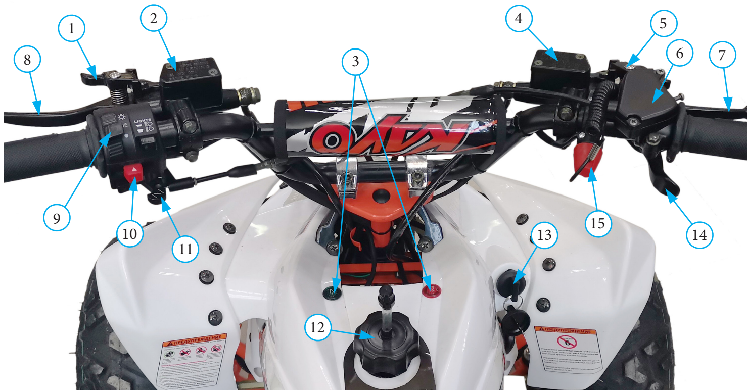
Фото 2.2. Приборы и органы управления транспортного средства: 1 – фиксатор стояночного заднего тормоза; 2 – бачок заднего тормоза; 3 – индикаторы (либо приборная панель); 4 – бачок переднего тормоза; 5 – фиксатор стояночного переднего тормоза; 6 – узел акселератора; 7 – рычаг переднего тормоза; 8 – рычаг заднего тормоза (либо рычаг сцепления для некоторых моделей); 9 – клавиша включения/выключения света; 10 – кнопка электростартера (вкл./выкл. двигателя); 11 – рычаг обогащения смеси; (для модели TOR на карбюраторе); 12 – крышка топливного бака с сапуном; 13 – замок зажигания; 14 – рычаг акселератора; 15 – чека аварийного выключения двигателя
