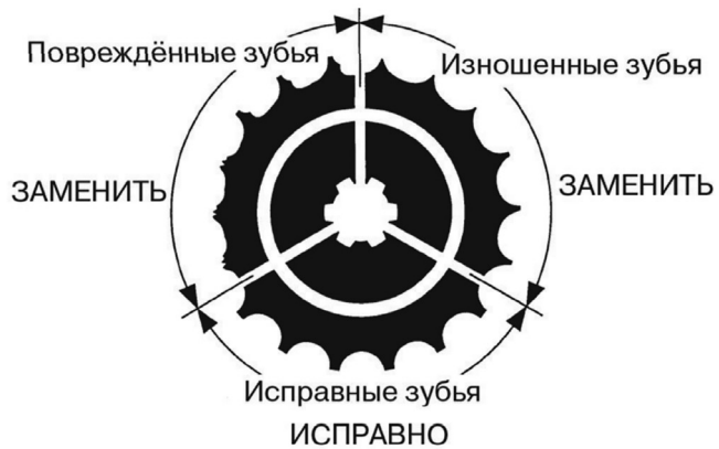
Рисунок 5.14. Вид зубьев звездочки
