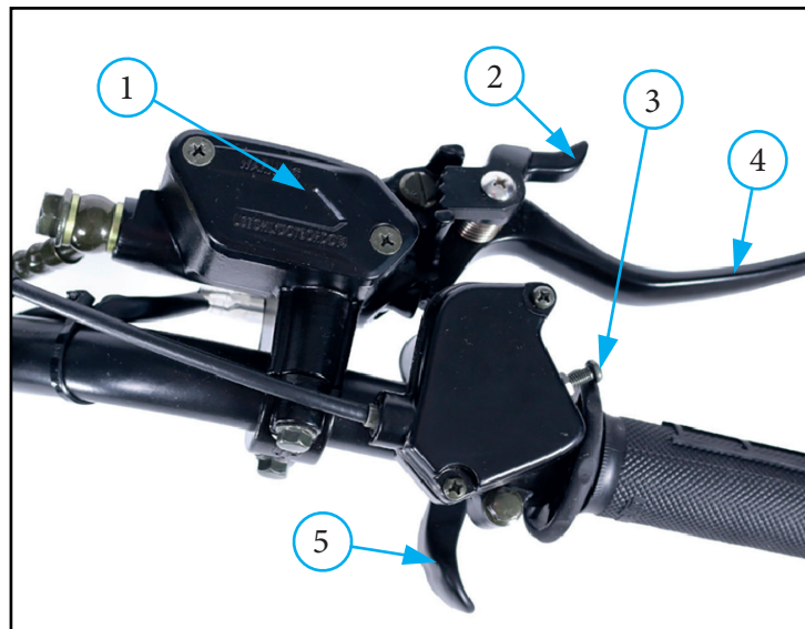
Фото 2.5. Переключатели правого рулевого блока: 1 – бачок переднего тормоза; 2 – фиксатор парковочного тормоза; 3 – регулятор ограничения акселератора; 4 – рычаг переднего тормоза; 5 – рычаг акселератора
