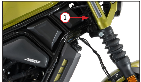
Фото 1.2 Идентификационный код транспортного средства (VIN) - 1 нанесен на правой стороне мотоцикла на раме
