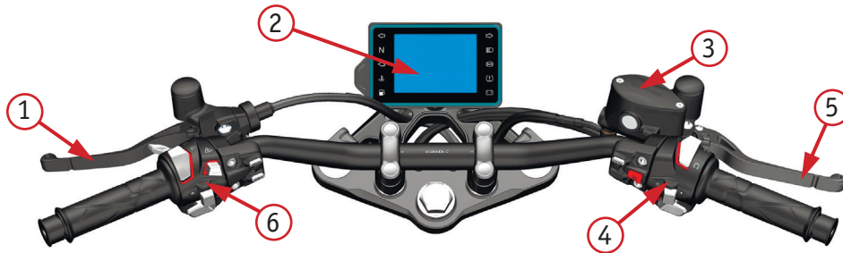
Фото 2.1. Вид руля и органов управления мотоцикла: 1 – рычаг сцепления; 2 – приборная панель; 3 – бачок для тормозной жидкости; 4 – правый комбинированный переключатель; 5 – рычаг переднего тормоза; 6 – левый комбинированный переключатель
