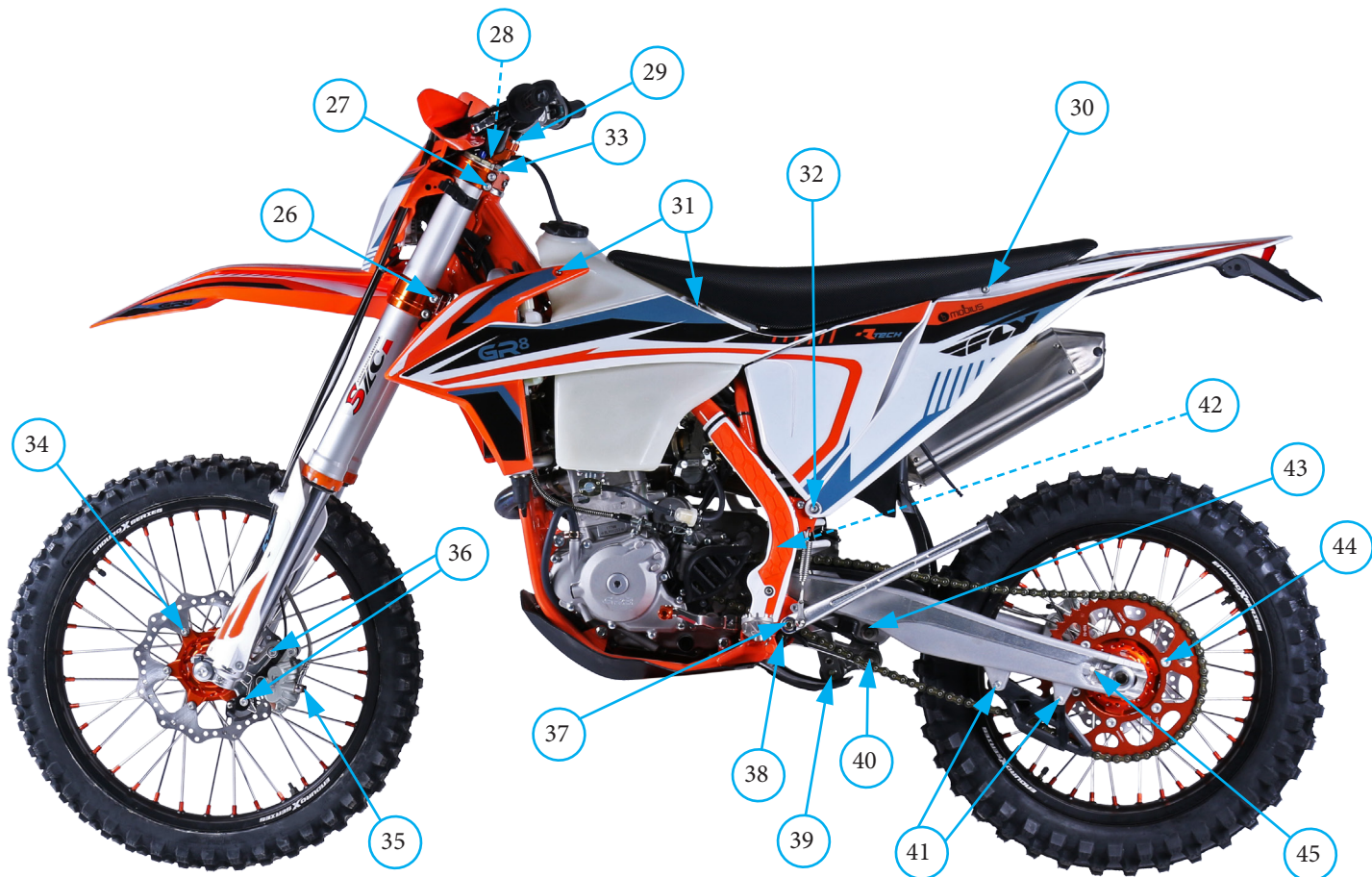
Фото 8.2. Места крепления (левая сторона).
