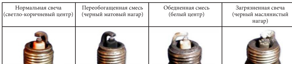
Фото 5.13. Состояния свечей зажигания.
