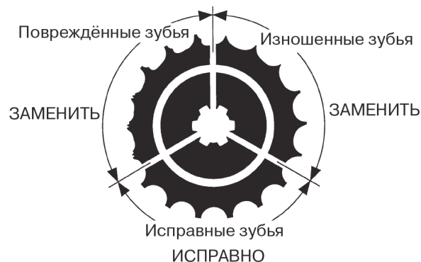
Рисунок 5.23. Вид зубьев звездочки.
