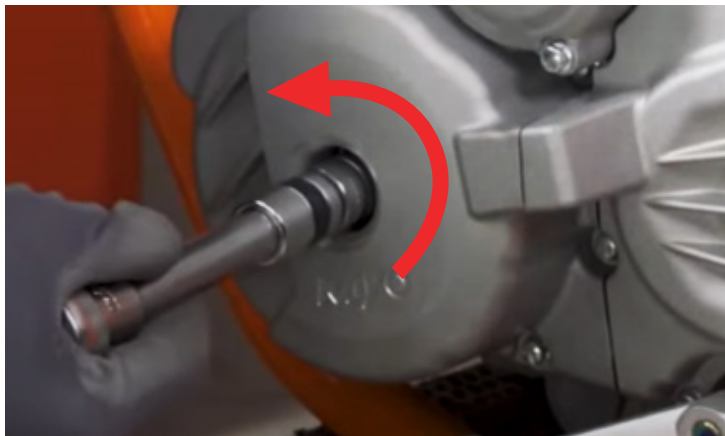
Фото 5.36. Направление вращения коленчатого вала.
