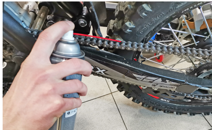
Фото 5.26. Очистка и смазка цепи.
