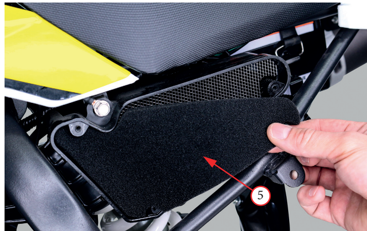
Фото 5.7. Обслуживание воздушного фильтра закрытого типа
