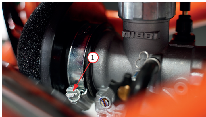
Фото 5.6. Крепление воздушного фильтра
