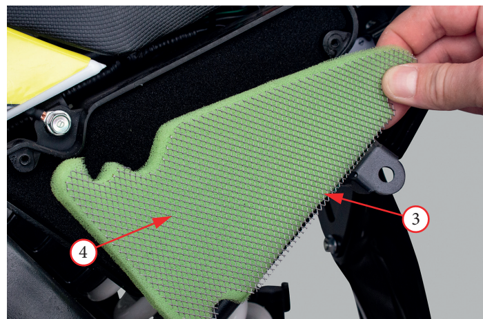
Фото 5.7. Обслуживание воздушного фильтра закрытого типа
