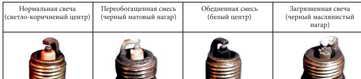
Фото 5.13. Состояния свечи зажигания
