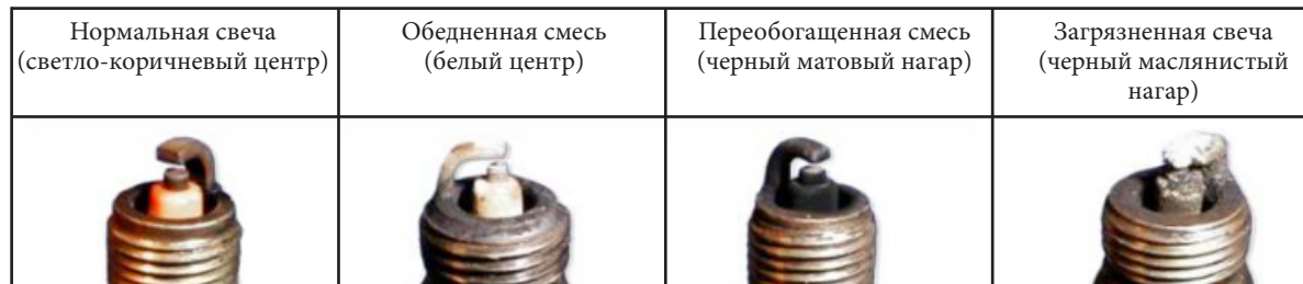
Фото 5.8. Состояния свечи зажигания.
