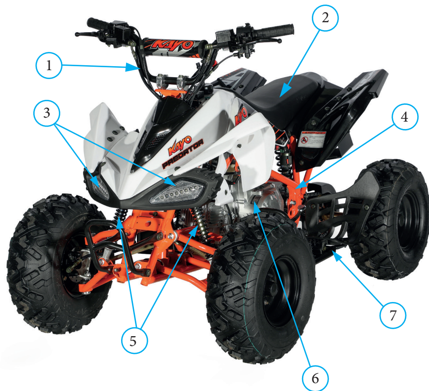
Фото 2.1. Левая сторона квадроцикла: 1 – руль с органами управления; 2 - сиденье; 3 – передние фары; 4 – рама; 5 - передняя подвеска; 6 – двигатель; 7 - левая подножка водителя.
