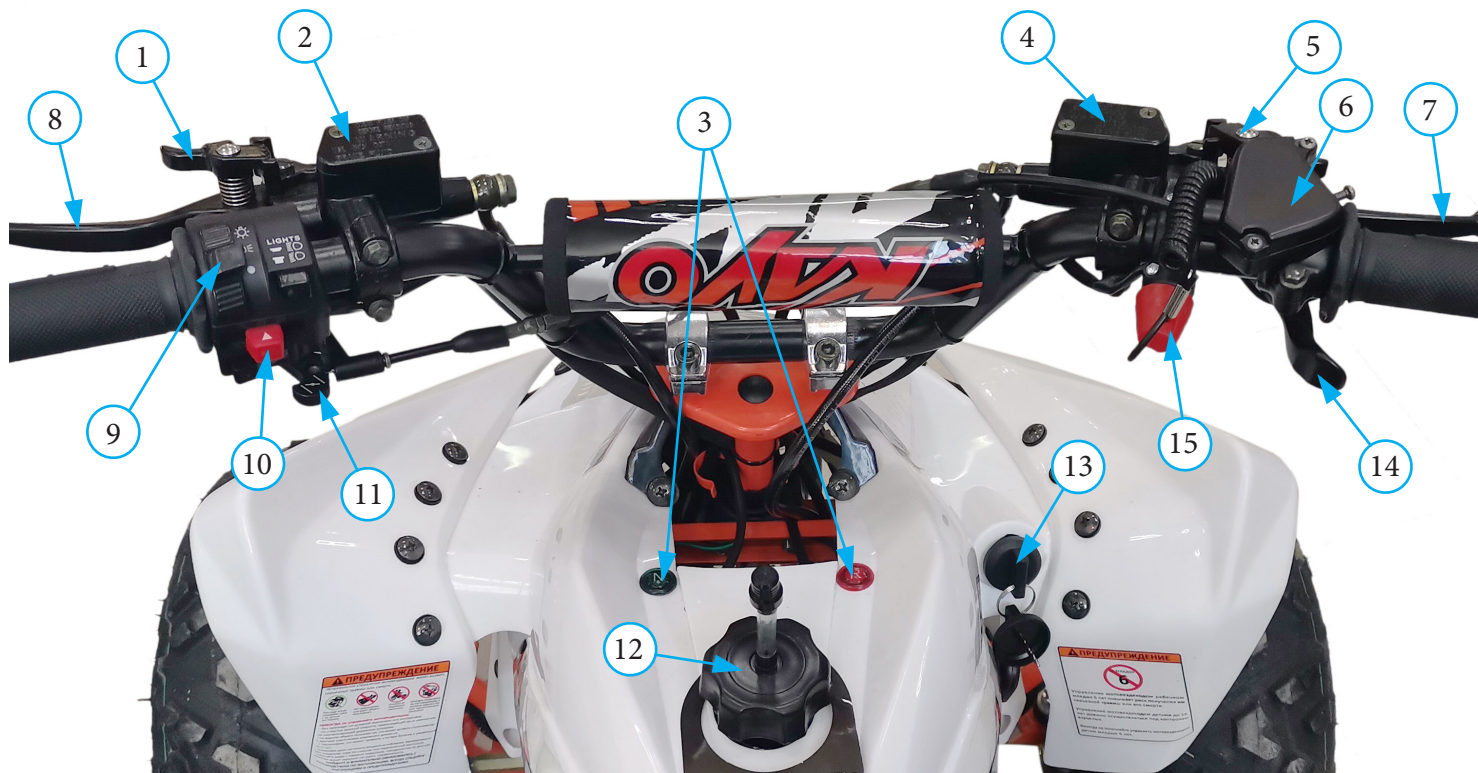
Фото 2.2. Приборы и органы управления квадроцикла: 1 - фиксатор стояночного заднего тормоза; 2 - бачок заднего тормоза; 3 - индикаторы (либо приборная панель); 4 - бачок переднего тормоза; 5 - фиксатор стояночного переднего тормоза; 6 - узел акселератора; 7 - рычаг переднего тормоза; 8 - рычаг заднего тормоза (либо рычаг сцепления для некоторых моделей); 9 - клавиша включения/выключения света; 10 - кнопка электростартера (вкл./выкл. двигателя); 11 - рычаг обогащения смеси (для модели TOR на карбюраторе); 12 - крышка топливного бака с сапуном; 13 - замок зажигания; 14 - рычаг акселератора; 15 - чека аварийного выключения двигателя (для MINI BULL).
