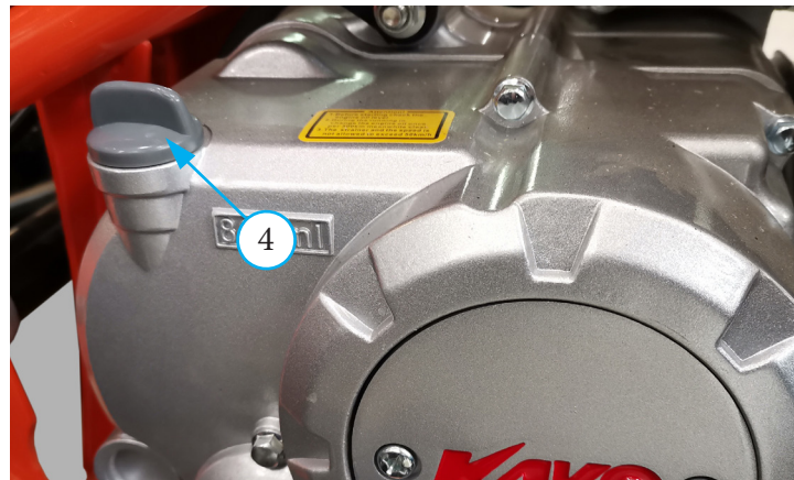
Фото 5.2. Варианты исполнения смотрового окна и крышки горловины двигателей: 1 - смотровое окно с указателями уровня (максимум - «2» и минимум - «3»); 4 - крышка маслозаливной горловины.
