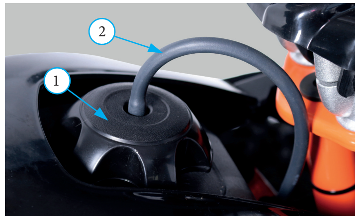
Фото 5.1. Крышка топливного бака - 1; трубка сапуна – 2.
