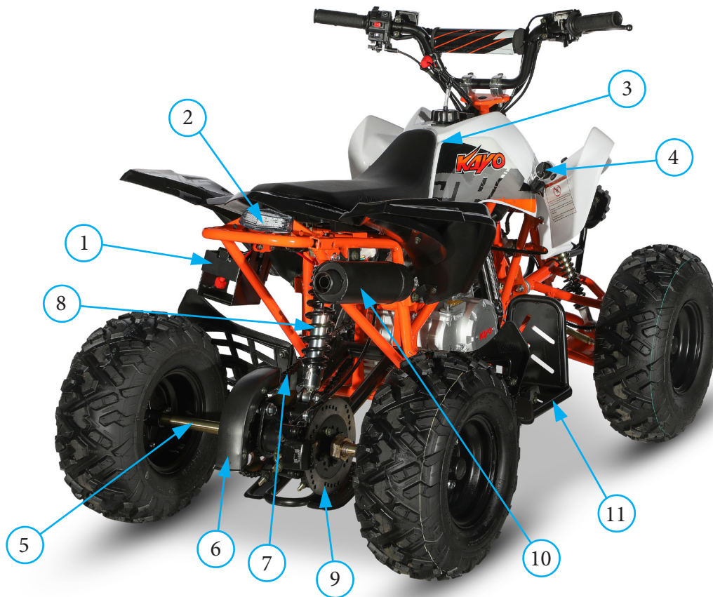
Фото 2.3. Вид с тыльной стороны квадроцикла: 1 - аккумуляторная батарея; 2 - задний фонарь; 3 - топливный бак; 4 - замок зажигания; 5 - ось задних колес; 6 - защита ведомой звезды; 7- приводная цепь; 8 - задний амортизатор; 9 - задний тормозной диск; 10 - глушитель; 11 - правая подножка водителя.
