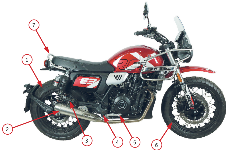
Фото 2.2. Вид справа: 1 – заднее колесо; 2 – глушитель; 3 – правая подножка пассажира; 4 – правая подножка водителя; 5 – педаль заднего тормоза; 6 – переднее колесо; 7 – поручень пассажира
