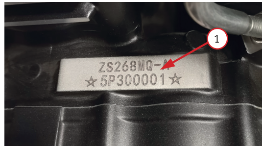
Фото 1.1. Справа на двигателе нанесен серийный номер двигателя – 1
