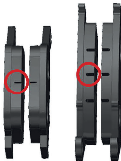
Фото 5.8. Определение износа тормозных колодок
