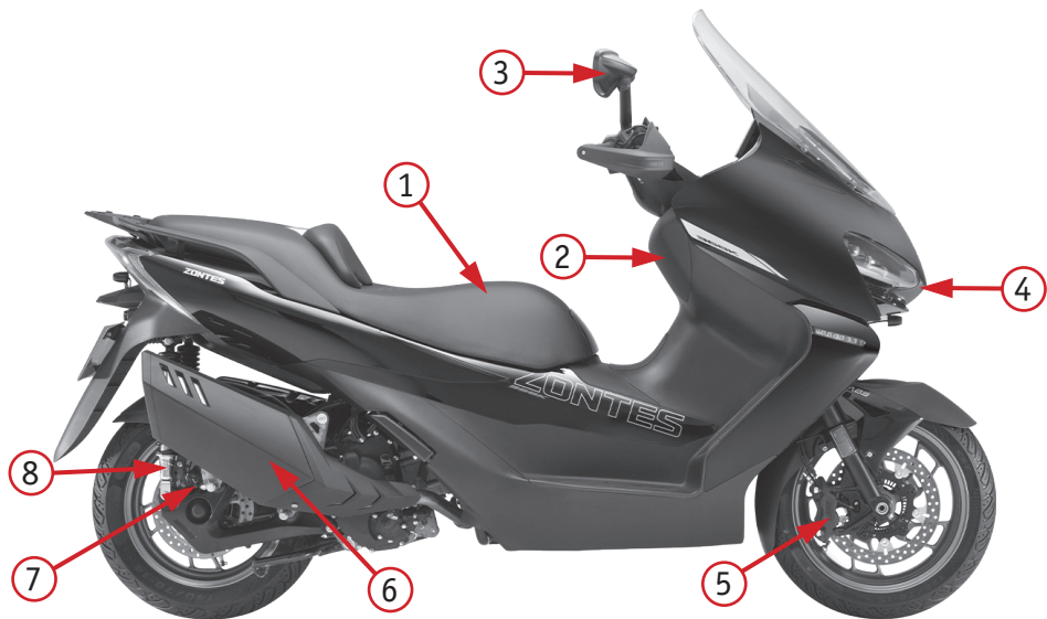
Фото 2.2. Вид справа: 1 – сиденье; 2 – правый ящик; 3 – зеркало заднего вида; 4 – передняя фара; 5 – передний тормозной суппорт; 6 – глушитель; 7 – задний тормозной суппорт; 8 – задний амортизатор
