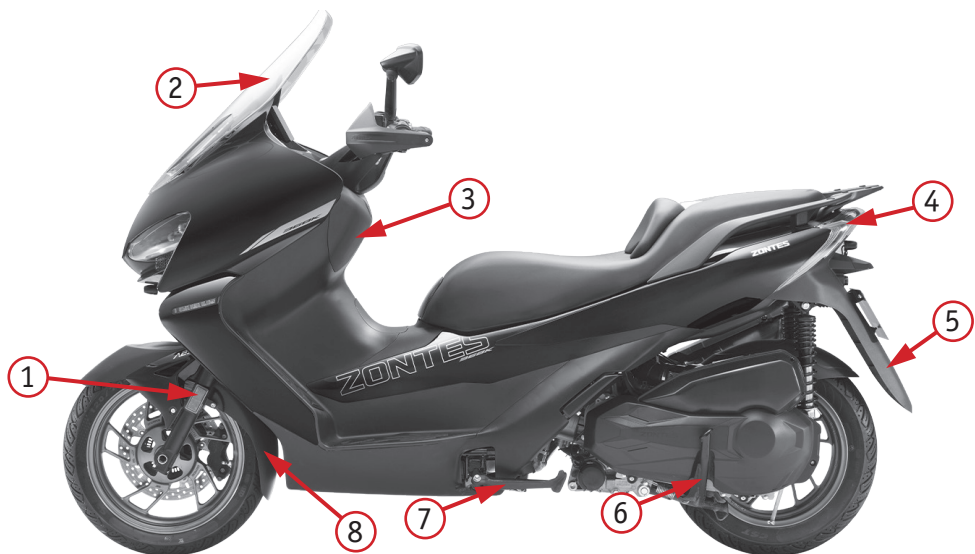
Фото 2.3 Вид слева: 1 – передние амортизаторы; 2 – ветровое стекло; 3 – левый ящик; 4 – задний фонарь; 5 – заднее крыло; 6 – центральная подставка скутера; 7 – боковая подставка; 8 – переднее крыло
