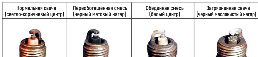
Фото 4.4. Состояния свечи зажигания
