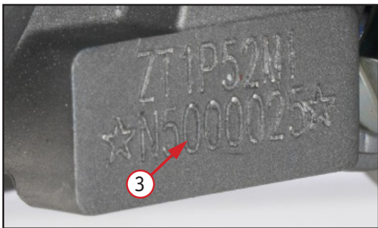
Фото 1.2. Серийный номер двигателя 3 нанесен слева на картере двигателя
