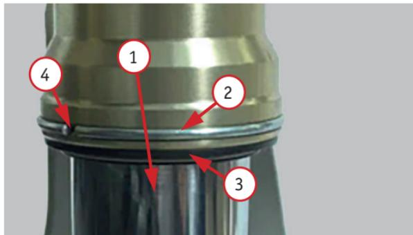
*Фото 4.9.1. Контролируемые части переднего амортизатора: 1 – перо амортизатора; 2 – изнашивающееся кольцо; 3 – уплотнение; 4 – торцевой зазор кольца*
