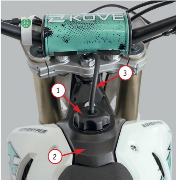
Фото 3. Открытие крышки топливного бака:
