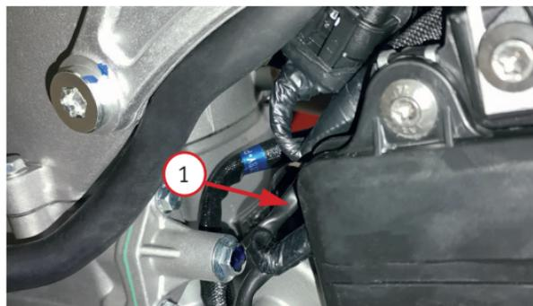
Фото 3.2. Предохранитель – 1 (15 А)
