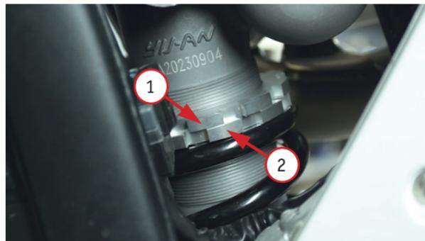
*Фото 4.9.5. Регулировка предварительного натяжения пружины: 1 – стопорная гайка; 2 – регулировочная гайка*
