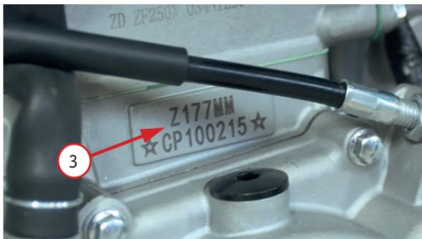
Фото 1.3. Справа на двигателе нанесен серийный номер двигателя 3
