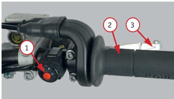
Фото 2.3. Правая сторона руля: 1 – кнопка электростартера; 2 – ручка газа; 3 – рычаг переднего тормоза
