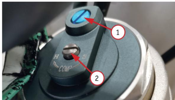
*Фото 4.9.2. Болт сброса давления 1 переднего амортизатора; 2 – болт регулировки демпфирования сжатия*
