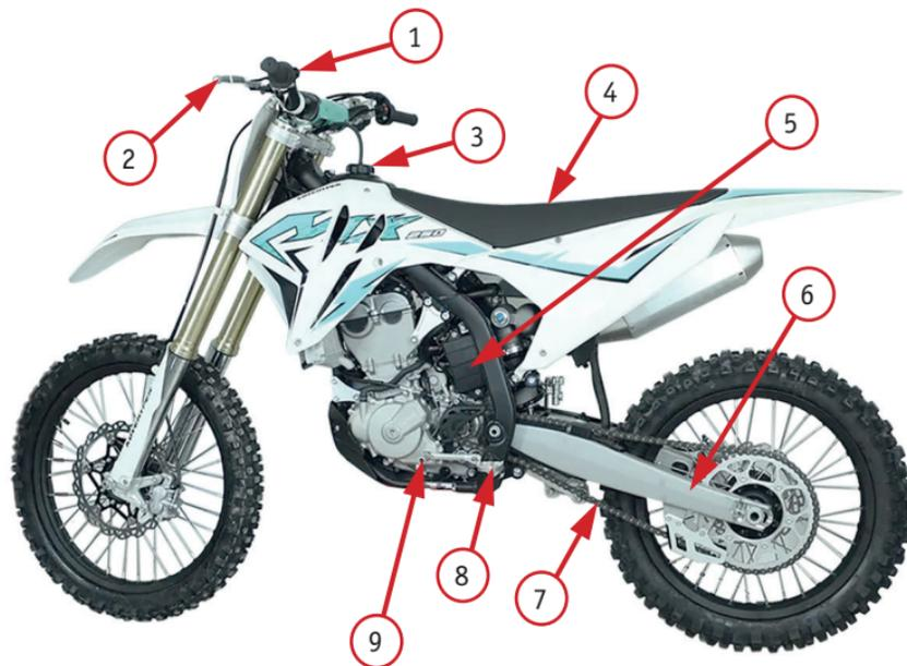
Фото 2.1. Вид мотоцикла слева: 1 – кнопка выключения зажигания; 2 – рычаг сцепления; 3 – крышка топливного бака; 4 – сиденье; 5 – аккумулятор; 6 – задний маятник; 7 – приводная цепь; 8 – левая подножка; 9 – педаль переключения передач
