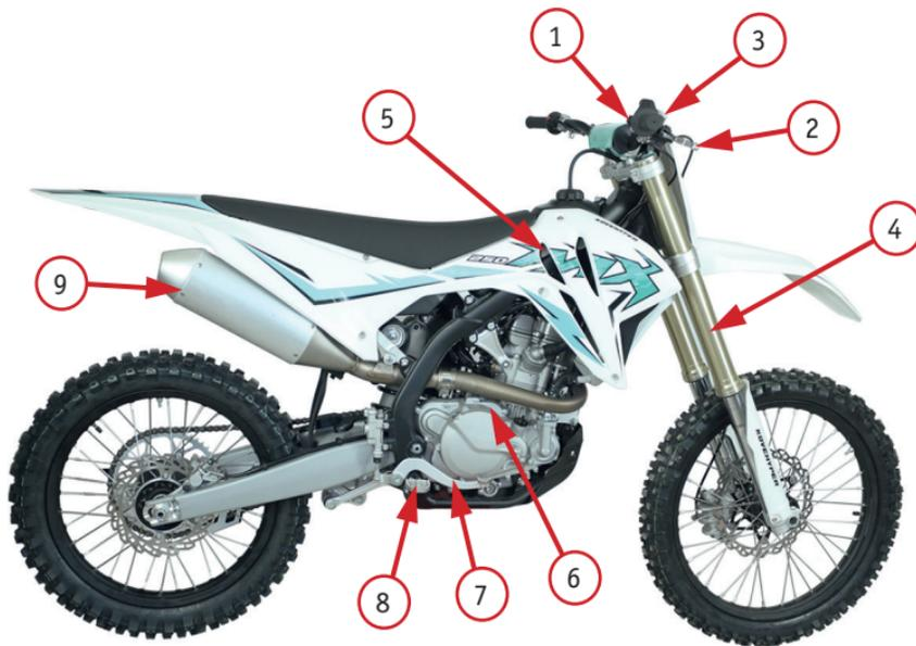
*Фото 2.2. Вид мотоцикла справа: 1 – электростартер; 2 – рычаг переднего тормоза; 3 – бачок тормозной жидкости переднего тормоза; 4 – перо переднего амортизатора; 5 – топливный бак; 6 – двигатель; 7 – педаль заднего тормоза; 8 – правая подножка; 9 – глушитель*
