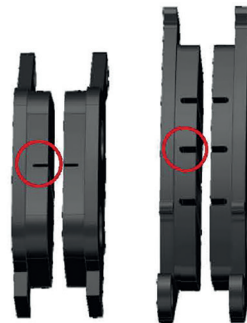
Фото 5.9. Определение износа тормозных колодок
