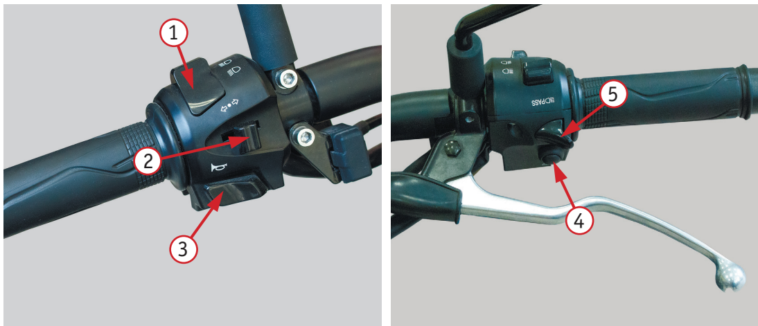
Фото 2.5.1 Левый комбинированный переключатель модели YL800: 1 – кнопка переключения режима света фары (дальний свет/ближний свет); 2 – переключатель указателей поворота; 3 – кнопка звукового сигнала; 4 – кнопка аварийной сигнализации; 5 – кнопка включения дальнего света при обгоне
