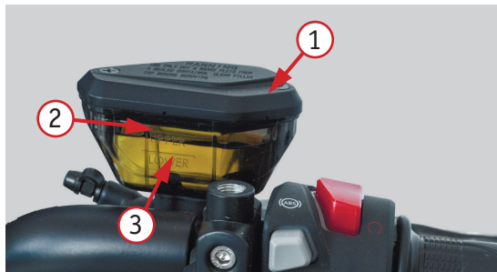
Фото 5.7.1 Уровень тормозной жидкости переднего тормоза: 1 – крышка; 2 – максимум; 3 – минимум
