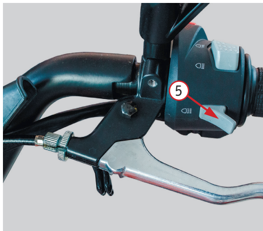
Фото 2.4 Левый комбинированный переключатель моделей ML800 и RL800: 1 – кнопка переключения режима света фары (дальний свет/ближний свет); 2 – переключатель указателей поворота; 3 – кнопка звукового сигнала; 4 – кнопка аварийной сигнализации; 5 – кнопка включения дальнего света при обгоне
