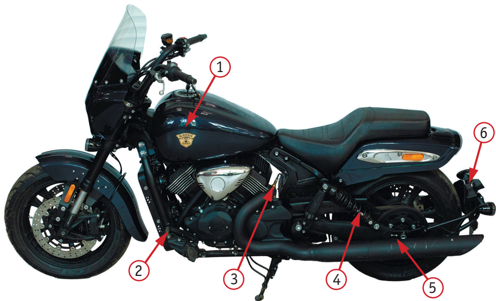
Фото 2.3. Вид слева: 1 – топливный бак; 2 – рычаг переключения передач; 3 – датчик кислорода; 4 – задний амортизатор; 5 – регулятор ремня; 6 – крепление номерного знака
