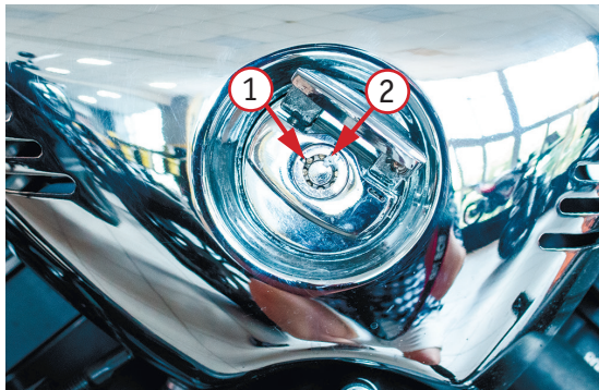
Фото 2.9.1 Замок зажигания: 1 – положение «Заблокировано»; 2 – положение «Разблокировано»
