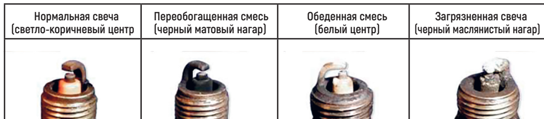
Фото 5.1. Состояния свечей зажигания
