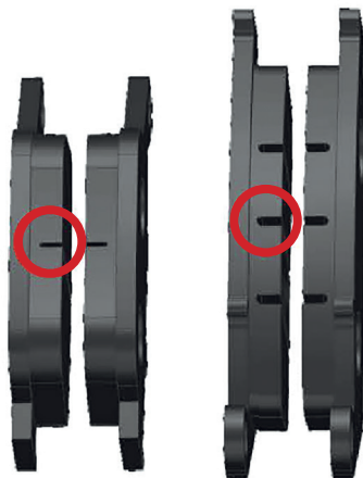
Фото 5.10. Определение износа тормозных колодок
