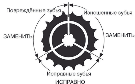
Рисунок 2. Износ звезд
