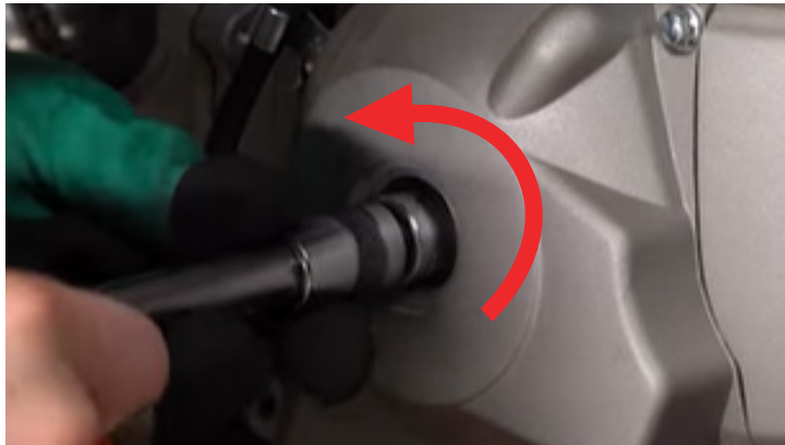
Фото 5.35. Направление вращения маховика коленчатого вала.
