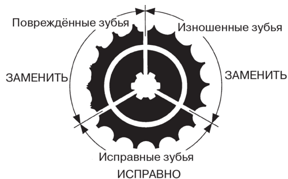
Рисунок 5.22. Вид зубьев звездочки.
