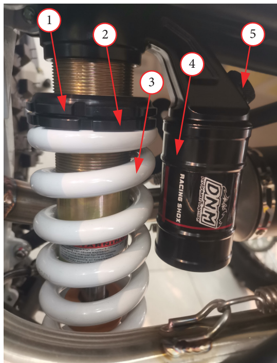
Фото 5.29. Регулировка преднатяга пружины и сопротивления сжатию заднего амортизатора.
