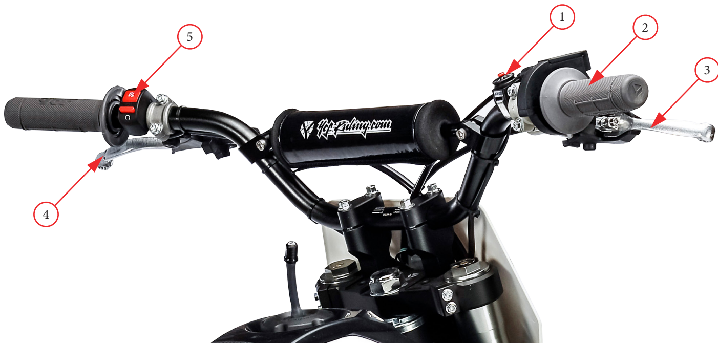
Фото 2.3. Приборы и органы управления питбайка: 1 - кнопка запуска двигателя (для моделей с электростартером); 2 - ручка акселератора; 3 - рычаг переднего тормоза; 4 - рычаг сцепления; 5 - кнопка выключения двигателя.
