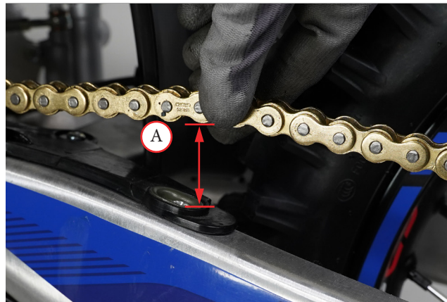
Фото 5.21. Замер провисания цепи.
