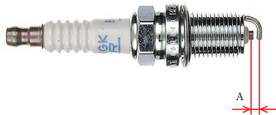
Фото 5.14. Зазор свечи зажигания.
