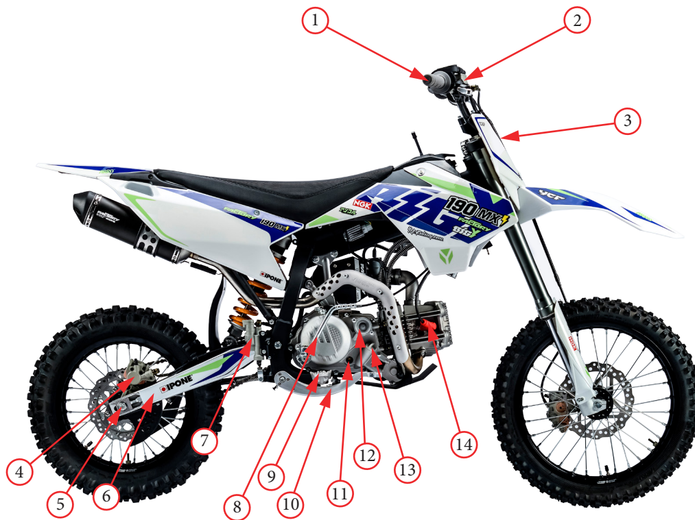
Фото 2.2. Правая сторона питбайка: 1 - ручка акселератора; 2 - передний тормозной бачок; 3 - передний щиток; 4 - задний суппорт; 5 - гайка крепления заднего колеса; 6 - вилка маятника; 7 - задний тормозной бачок; 8 - рычаг кик-стартера; 9 - подножка водителя правая; 10 - педаль заднего тормоза; 11 - окно контроля уровня масла; 12 - крышка масляного фильтра; 13 - крышка маслозаливной горловины; 14 - свечной колпачок.
