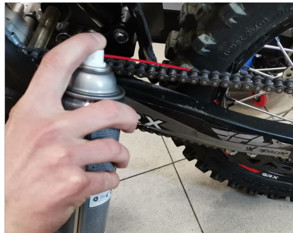
Фото 5.25. Очистка и смазка цепи.
