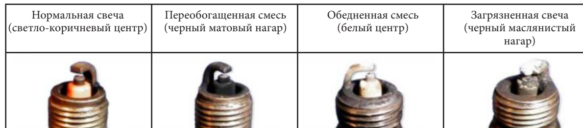
Фото 5.13. Состояния свечей зажигания.
