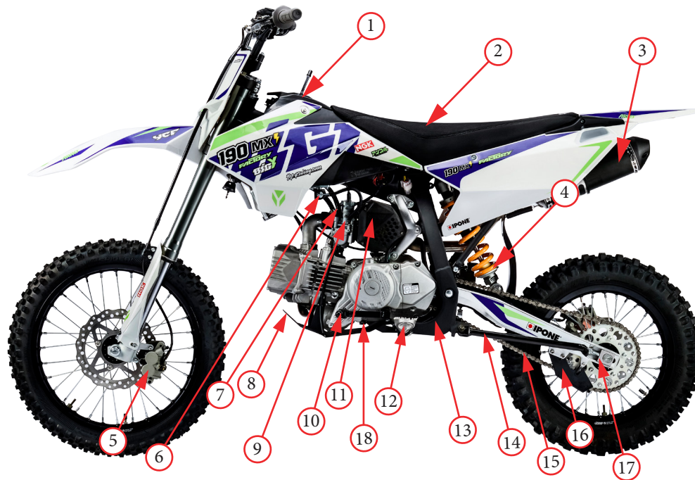
Фото 2.1. Левая сторона питбайка: 1 - крышка топливного бака с сапуном; 2 - сиденье; 3 - искрогаситель; 4 - задний амортизатор; 5 - передний суппорт; 6 - топливный кран; 7 - рычаг обогатителя топливной смеси; 8 - защита двигателя; 9 - карбюратор; 10 - рычаг переключения передач; 11 - воздушный фильтр; 12 - подножка водителя левая; 13 - ролик натяжения цепи (за рамой); 14 - подставка боковая; 15 - приводная цепь; 16 - уловитель цепи; 17- кронштейн натяжения цепи; 18 - винт для слива масла.
