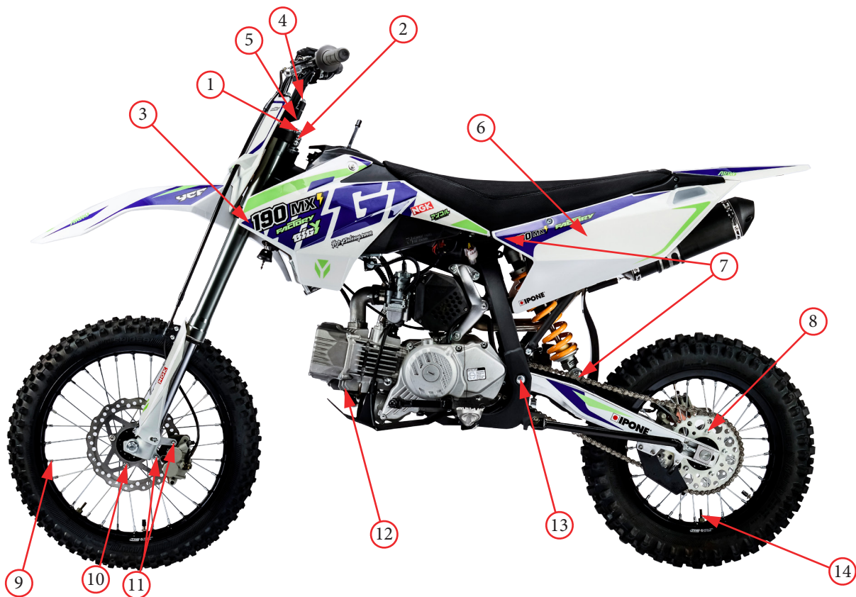
Фото 8.1. Расположение крепежных мест (левая сторона).
