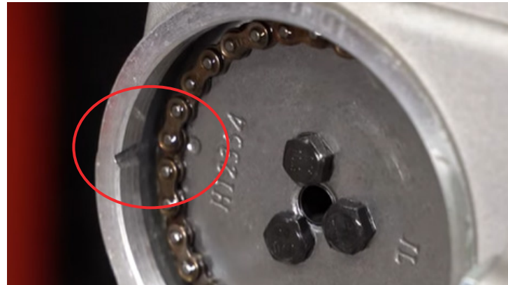
Фото 5.36. Совмещение меток в окне размещения звезды.
